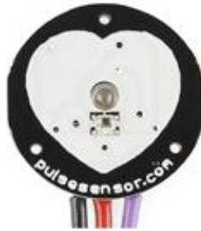
**Figura 2.5.** Sensor para medir el pulso por PPG de pulsesensor. En esta imagen se puede apreciar que el emisor y el detector se encuentran en configuración de reflexión.
