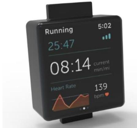
**Figura 4.3.** Prototipo de cubierta creado con SolidEdge, en el cual se respetan las medidas de la correa Polar A300.
