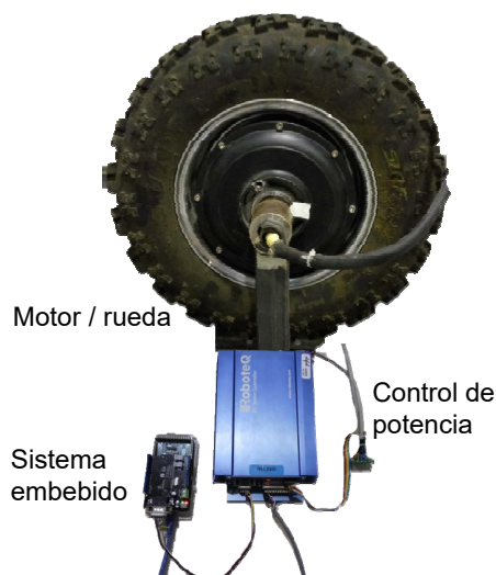
Figura 2: Fotografía del sistema experimental, compuesto por la rueda, la controladora industrial HBL2360 y una placa Arduino Due dotada de un interfaz para comunicaciones con bus CAN.
