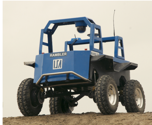
Figura 1: El vehículo terrestre no tripulado Rambler incorpora un motor BLDC en cada rueda.
