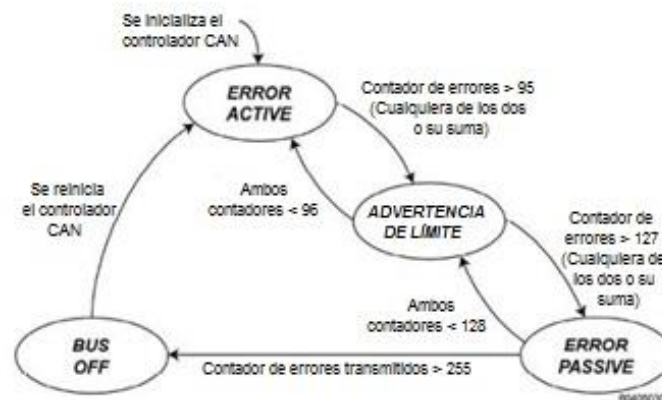
Fig. 9: Máquina de estados de error de los nodos CAN.
