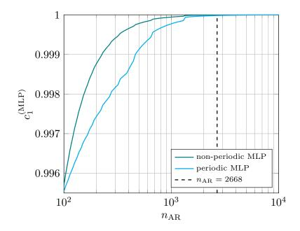
Figure A.15: Máxima probabilidad de captura,  $c_1^{(\text{MLP})}$ , para  $n_{\text{AR}}$  de 10<sup>2</sup> a 10<sup>4</sup>, con MLP  $(d_{\text{safe}} = 42 \text{ m})$  para mensajes periódicos y no periódicos.  $r_{\text{bc}} = 150 \text{ m}$ ,  $d_{\text{max}} = 56 \text{ km y}$   $\gamma = 5 \text{ dB}$ .
