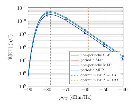
Figure A.16: EE media en función de la potencia de transmisión por Hz,  $\rho_{\rm VT}$ , para SLP  $(d_{\rm safe} = 0 \text{ m})$  y MLP  $(d_{\rm safe} = 42 \text{ m})$  con mensajes periódicos y no periódicos.
