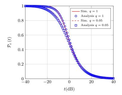
Figure A.10: Probabilidad de cobertura en función de la SINR umbral, t, para q = 1 y q = 0.05.
