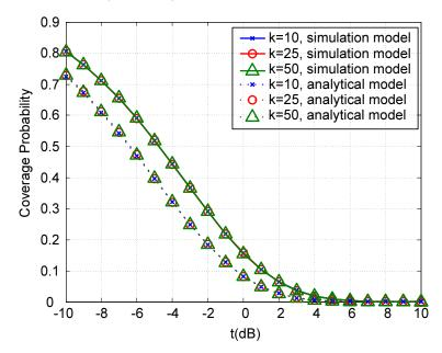
Figure A.9: Probabilidad de cobertura para  $k = \{10, 25, 50\}$  con compensación total de las pérdidas de propagación ( $\epsilon = 1$ ), para el caso sin ruido con  $\alpha = 2.5$ ,  $\lambda_b = 0.24$ .
