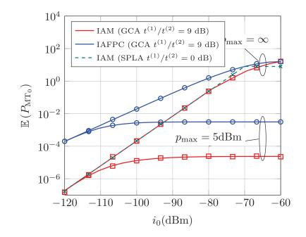
Figure A.4: Potencia media transmitida en función de  $i_0$  para IAM y IAFPC con  $\epsilon = 1$  y dos valores de la potencia máxima de transmisión:  $p_{\text{max}} \rightarrow \infty$  y  $p_{\text{max}} = 5$  dBm.
