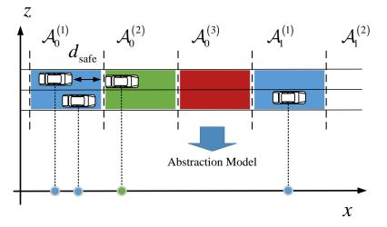
Figure A.12: Diagrama de GLOC con SLP para una carretera de dos carriles y 3 ARs. Los distintos colores están asociados a distintos ARs. En la parte inferior de la figura se muestra el modelo de abstracción usado para el análisis donde las posiciones de los vehículos son puntos en la recta real.
