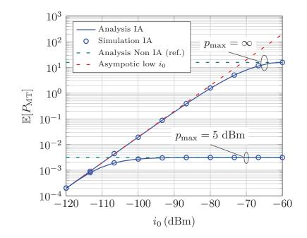
Figure A.1: Potencia media transmitida en función de  $i_0$  para IAFPC y FPC clásico (incosciente de la interferencia) con  $\epsilon = 1$ ,  $p_{\text{max}} \to \infty$  y  $p_{\text{max}} = 5$  dBm.
