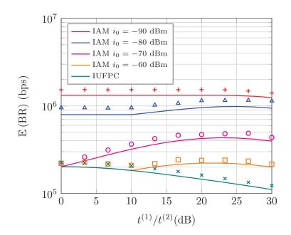
Figure A.6: BR medio como función de  $t^{(1)}/t^{(2)}$  para FPC  $(i_0 \rightarrow \infty)$  y IAM con  $i_0 = \{-90, -80, -70, -60\}$  dBm y  $p_{\text{max}} \rightarrow \infty$ .
