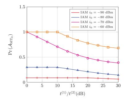
Figure A.7: Probabilidad de estar activo para el MT típico en función de  $t^{(1)}/t^{(2)}$  para IAM con  $i_0 = \{-90, -80, -70, -60\}$  dBm y  $p_{\text{max}} \to \infty$ .
