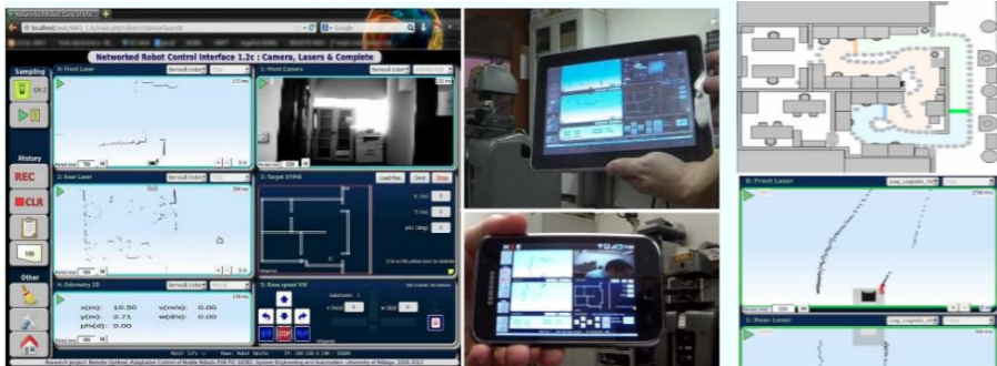
Figura 25. Izquierda y en medio) Nuestro interfaz en un experimento de navegación remota real, que se puede ejecutar en tres plataformas diferentes: un PC de escritorio, una tablet y un teléfono inteligente sin variar la implementación. Derecha-arriba) Camino correspondiente a uno de nuestros laboratorios, donde se han realizado los experimentos de este trabajo. Derecha-abajo) Instante del experimento donde el robot sale de los límites del camino, lo que se indica al usuario mediante un cambio de color de negro a rojo en los datos del sensor del láser.
