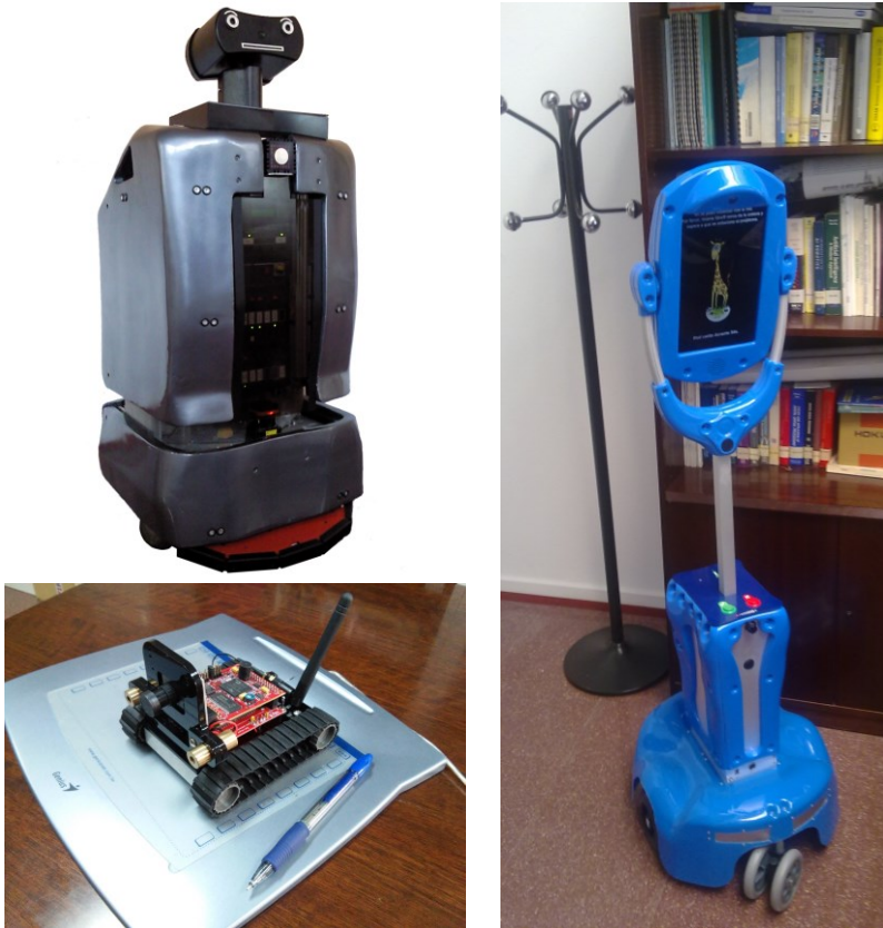
Figura 2. Robots utilizados para los escenarios reales: prototipo SANCHO [48] (izquierda-arriba), Surveyor SRV-1 [49] (izquierda-abajo) y GIRAFF [46] (derecha).
