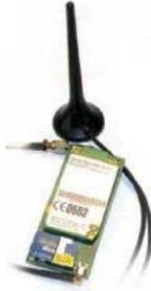
Figura 8. Detalle de tarjeta-modem GSM para inversor Ingecon.
