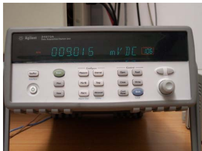
Figura 5. Sistema Data Acquisition 34970A. Dispone de interfaz GPIB y RS232. Dispone de tres bahías para distintos tipos de tarjetas.
