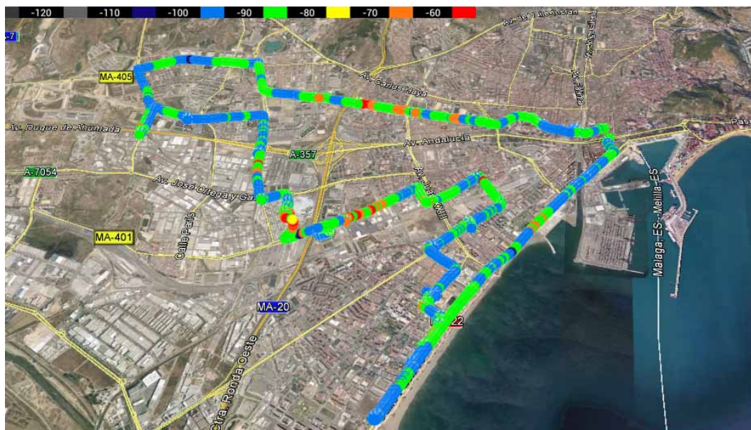
Figura 2.33: Recorrido seguido en Málaga durante la realización del drive test . Se muestra el mapa de nivel de señal RSCP (dBm) que fue exportado desde la aplicación G-Net Track.
