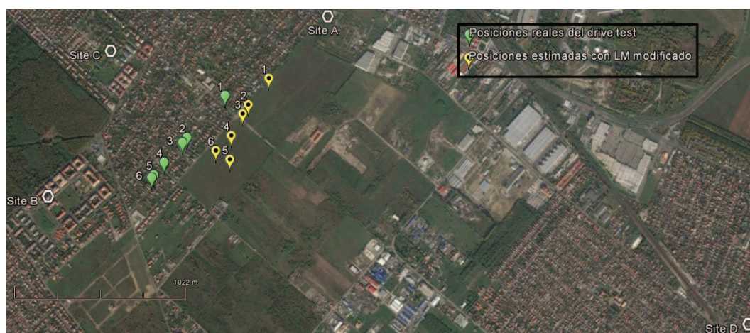
Figura 3.36: Geolocalización representada sobre Google Earth para un escenario real sub-urbano de Europa. Se muestra la comparativa entra las localizaciones reales dadas por el GPS del drive test (marcadores verdes vacíos) y las localizaciones estimadas por LM modificado (marcadores amarillos con punto negro). Por su parte, los sites han sido representados con hexágonos blancos, teniendo en cuenta que el site 'A' es el site de referencia.
