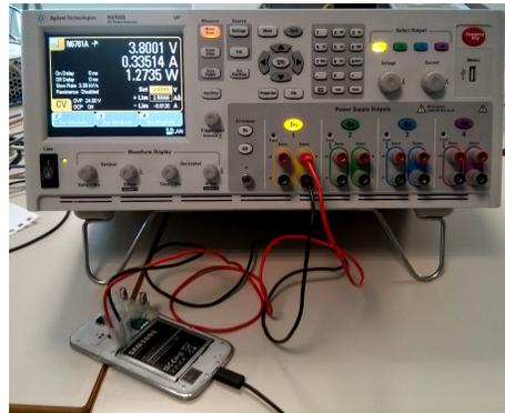
Figura 10.3: Analizador de energía al dispositivo ANDROID
