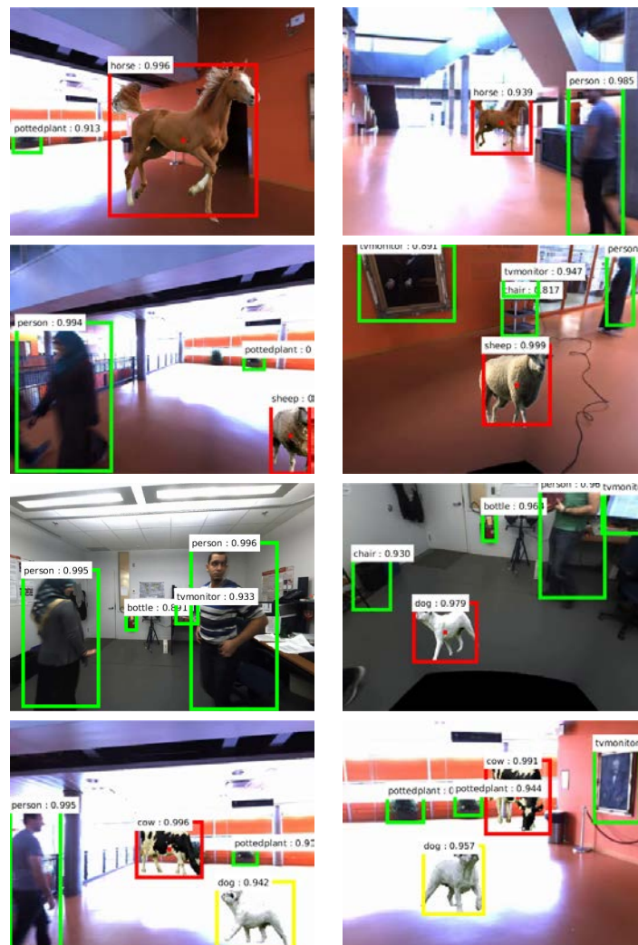
Figura 9.7: Algunos fotogramas con los resultados de salida del módulo de detección y clasificación de objetos. Los objetos no anómalos detectados presentan una región mínima rectangular verde, el objeto más anómalo se muestra en rojo, y el resto de objetos anómalos, si existen, están coloreados en amarillo. Cada fila muestra dos fotogramas de un video probado. De arriba abajo (y de izquierda a derecha): escenario3horse_0 (608 y 875), escenario3sheep_0 (352 y 481), escenario5dog_270 (186 y 691) y escenario3dogcow_0 (188 y 329).
