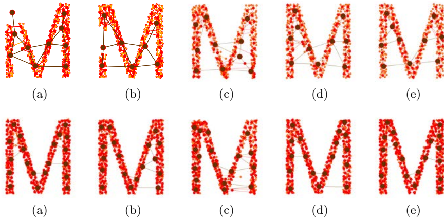
Figura 7.3: Resultados del GHBNG para la distribución de entrada de la letra M utilizando \tau = 0,2 (primera fila), \tau = 0,1 (segunda fila) y las diferentes divergencias de Bregman: (a) distancia euclídea cuadrada, (b) divergencia I-Generalizada, (c) distancia de Itakura-Saito, (d) pérdida exponencial y (e) pérdida logística. Las neuronas se representan por círculos y las conexiones entre las neuronas se representan por líneas rectas, donde las capas superiores se muestran en tonos más oscuros y con un tamaño más grande que las capas más profundas.
