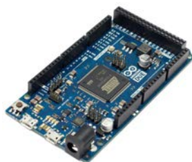
Figura 5.1: Placa Arduino DUE utilizada para la implementación del modelo de detección de movimiento basado en SOM.
