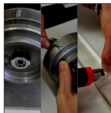
Figura 3.3. Distintos pasos del proceso del montaje de las muestras.
