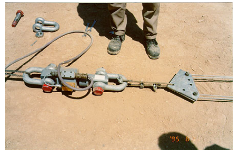
Ilustración 8-6. Colocación de cables y cédulas de carga
