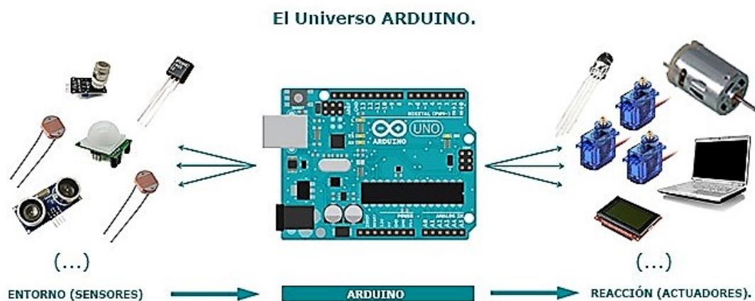
Figura 3.4: Entorno Arduino interpretado como intermediario E/S(Crespo, 2016).
