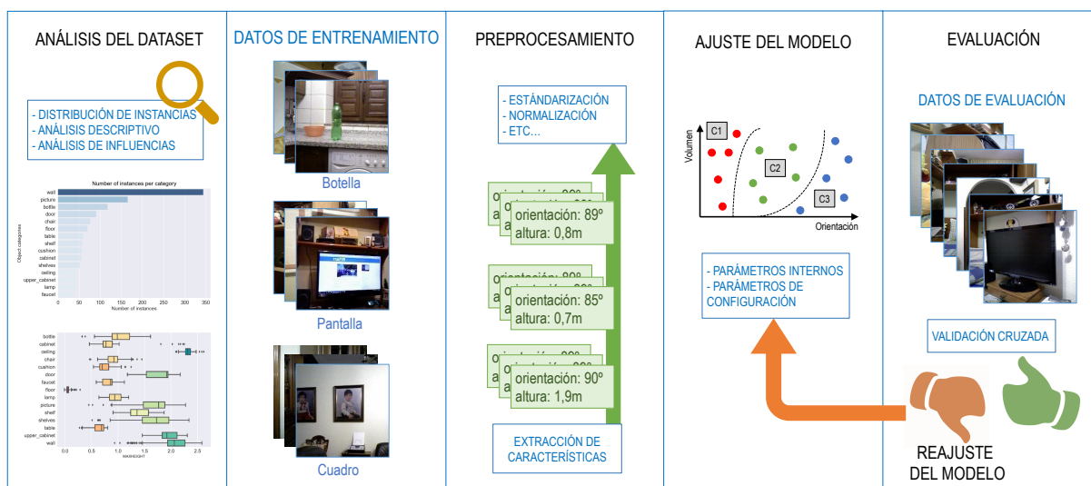
Figura 1: Pasos típicos a seguir en la etapa de diseño de un sistema de reconocimiento de objetos.
