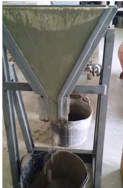
Figura 4-14. Ensayo de escurrimiento del hormigón HACE, según UNE 83364
