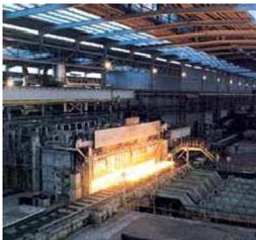
Figura 1-7. Horno de vigas galopantes. Fuente RC09
