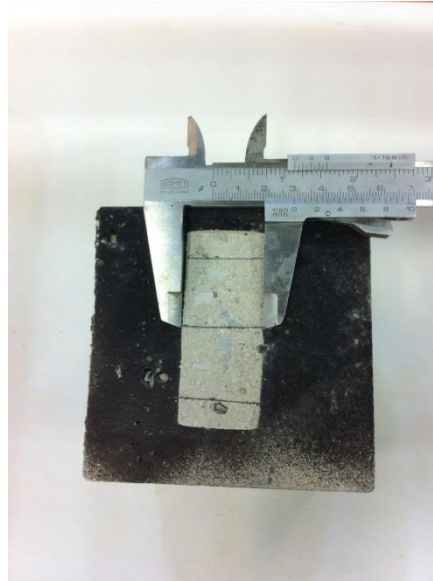
Figura 5-29. Medida del ancho central en la huella de abrasión
