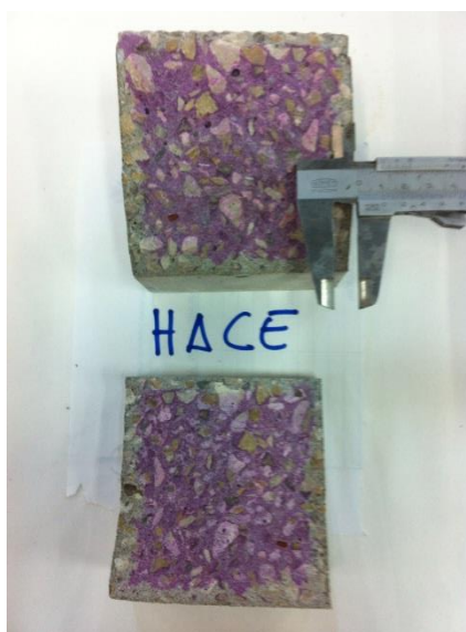
Figura 5.34. Medición de la profundidad de penetración
