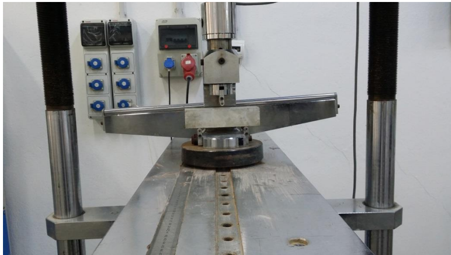
Figura 5-20. Equipo utilizado en el ensayo de flexotracción
