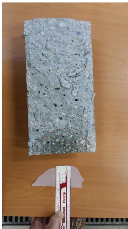
Figura 5-7. Frente de penetración de agua de una amasada HACE
