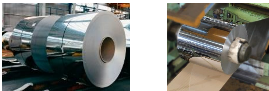
Figura 1-11. Proceso de laminación en frío y producto acabado. Fuente RC09
