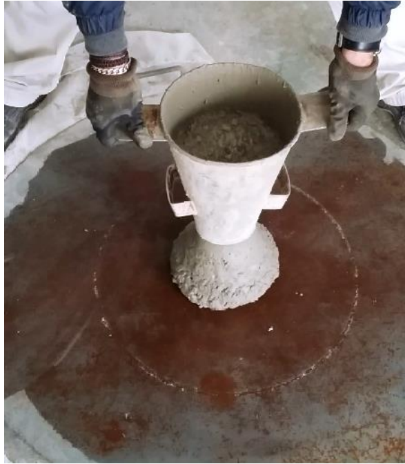
Figura 4-13. Ensayo de escurrimiento del hormigón HACE, según UNE 83361
