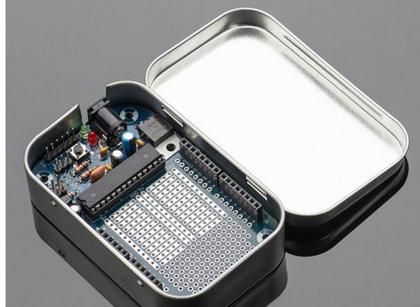
Figura 3.4: Adafruit Menta Kit como base del montaje de nuestro simulador de ECG (Menta, 2017).
