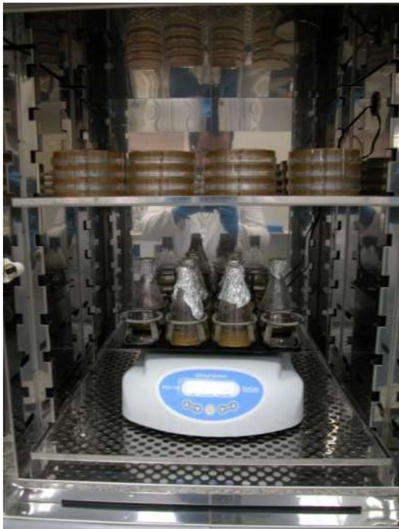
Fig. 30. Incubación de los cultivos a 30°C y en agitación orbital a 300rpm.
