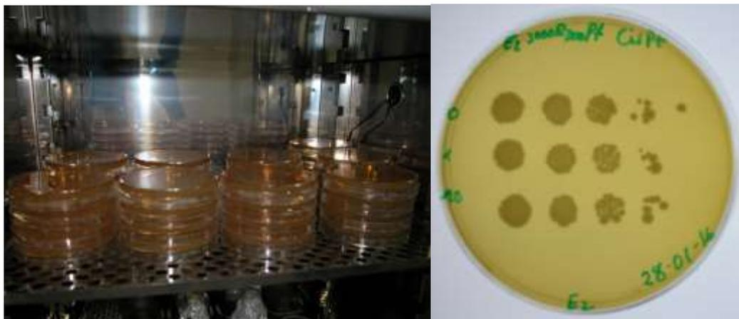
Fig. 27. Incubación de placas en estufa a 30°C y ejemplo de drop test.
