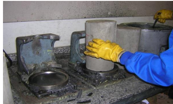
Refrentado. Obtención de la planeidad de la cara superior de la probeta
