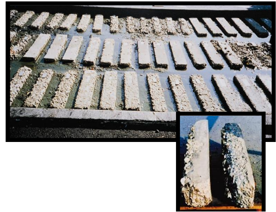
Figura 2-4: Degradación del hormigón en presencia de sulfatos
