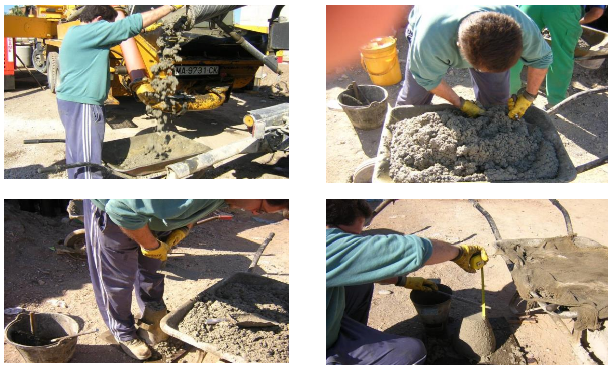
Fig. 3-1 Ensayo del cono de Abrams para la medida de la consistencia
