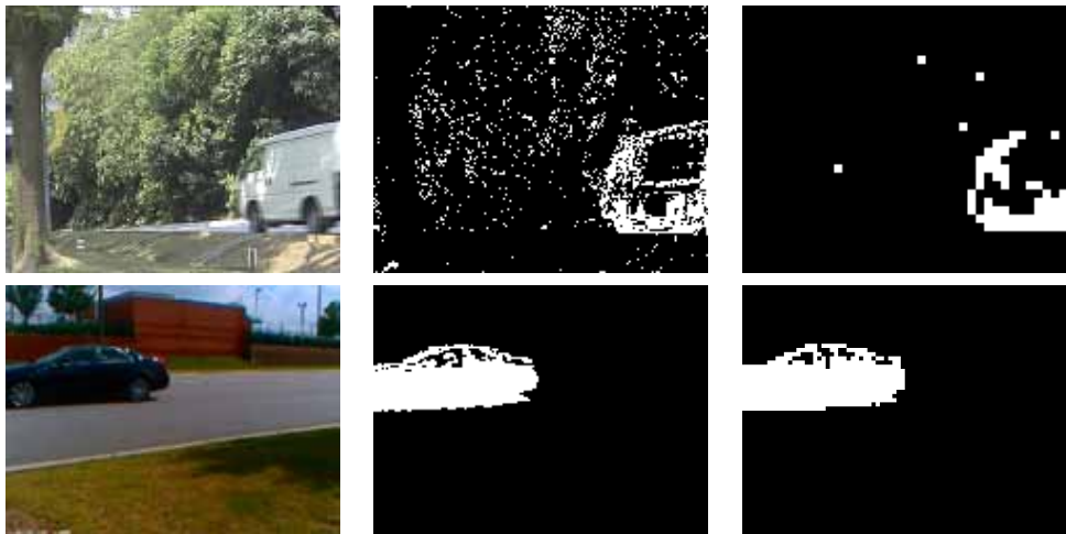
Figura 2.10: Resultados del modelo de doble diferencia. De izquierda a derecha: fotograma actual, resultado al utilizar el modelo de doble diferencia sin usar bloques y resultado usando bloques 4x4. Fuente: elaboración propia.
