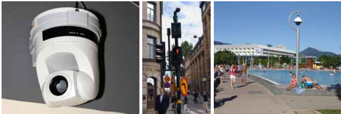
Figura 7.1: Ejemplos de cámaras no estáticas. De izquierda a derecha: cámara PTZ en interior, cámara PTZ para videovigilancia de un cruce de calles y cámara domo en una zona de ocio. Una cámara domo es esencialmente una cámara PTZ a la que se le añade una cúpula para protegerla y ocultar su orientación. Fuente Wikipedia.
