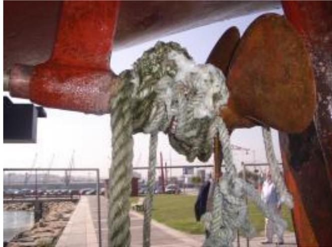
Ilustración 20. Enredos en sistemas propulsores. Fuente: foro.latabernadelpuerto.com
