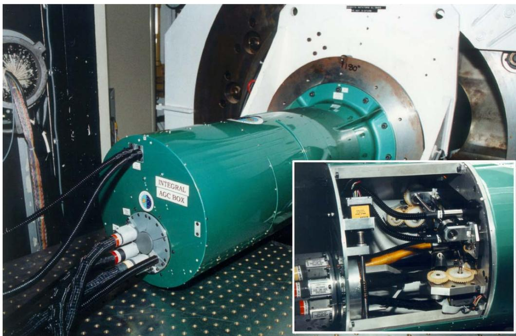
Figura 3.1: Estructura de adquisición, guiado y calibración de INTEGRAL tal y como está colocado en el telescopio WHT.
