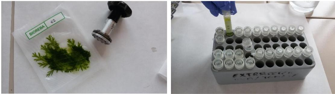
**Foto 23.** Bolsa BIOREBA (izquierda) después del triturado con el homogeneizador de rodamientos a bolas (izquierda) y muestras de extracto crudo en tubos Eppendorf de 1,5 ml (derecha)
