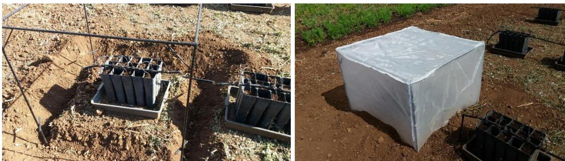
**Foto 17.** Montaje de la estructura metálica alrededor de la bandeja (izquierda) y estructura finalizada con malla (derecha).
