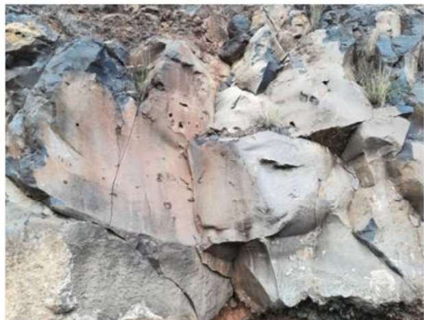
Figura 4.5. Ejemplos de grados de fracturación. A la derecha macizo masivo, a la izquierda poco fracturado. (Fotos: Ana Miranda).
