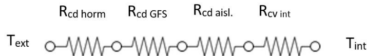
Figura 3. Esquema de resistencias térmicas del suelo del tanque de digestión. Fuente: elaboración propia.
