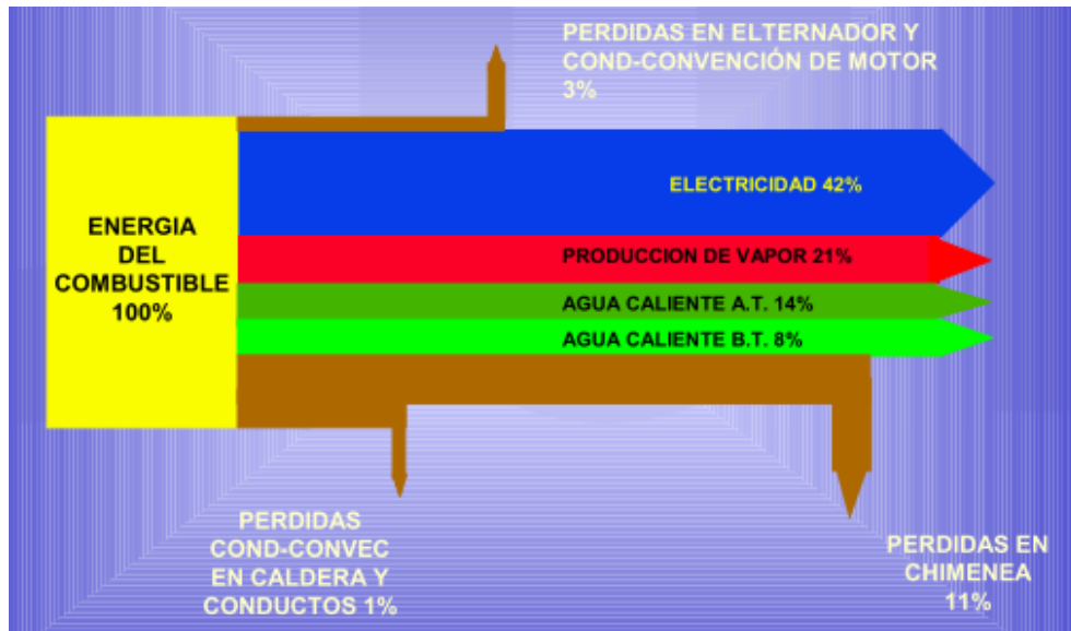
Figura 3. Diagrama de Sankey de planta de cogeneración con motor de gas. Fuente: eoi
