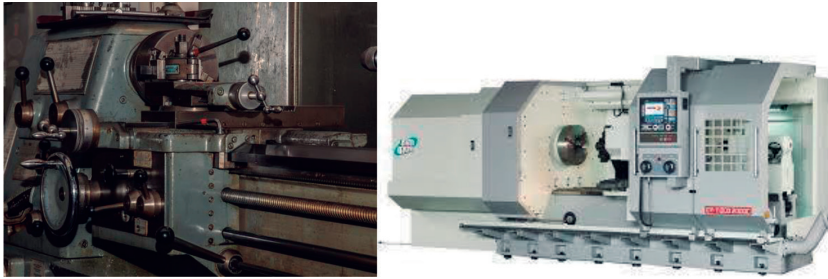
Figura 4. Evolución de un torno. El de la izquierda con automatismos de lógica mecánica, generalmente actuados por un solo motor principal (Licencia CC0 Creative Commons). El de la derecha con automatismos electrónicos y accionamientos eléctricos, generalmente un motor asignado a cada tarea (Licencia https://creativecommons.org/licenses/by-nd/2.0/ ( sitio: https://flickr.com/photos/502943984@N04/14140503632 ).
