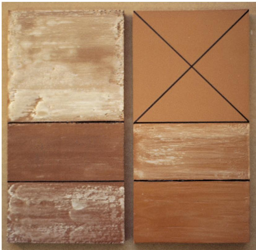
Fig. III-7. Estabilidad y resistencia de la cera ceresina frente a los disolventes.
