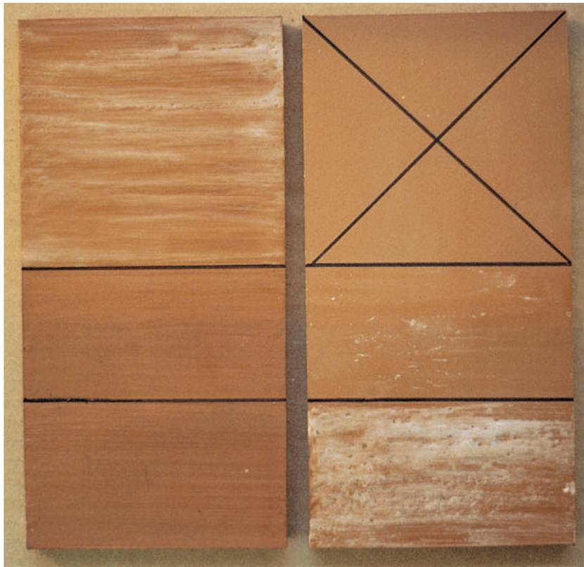
Fig. III-8. Estabilidad y resistencia de la parafina frente a los disolventes.
