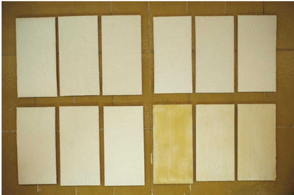
Fig. IV-4. Ensayo de estabilidad a la luz de los morteros.
