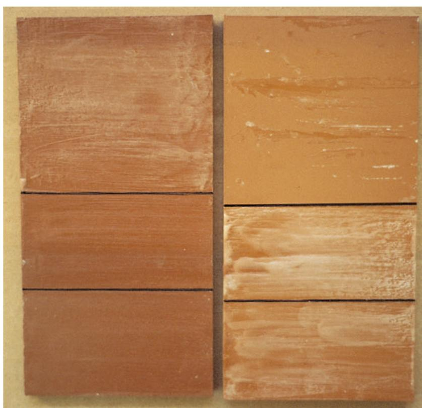
Fig. III-9. Estabilidad y resistencia de la cera microcristalina -Cosmolloid 80H- frente a los disolventes.
