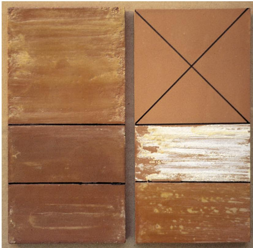
Fig. III-5. Estabilidad y resistencia de la cera candelilla frente a los disolventes.
