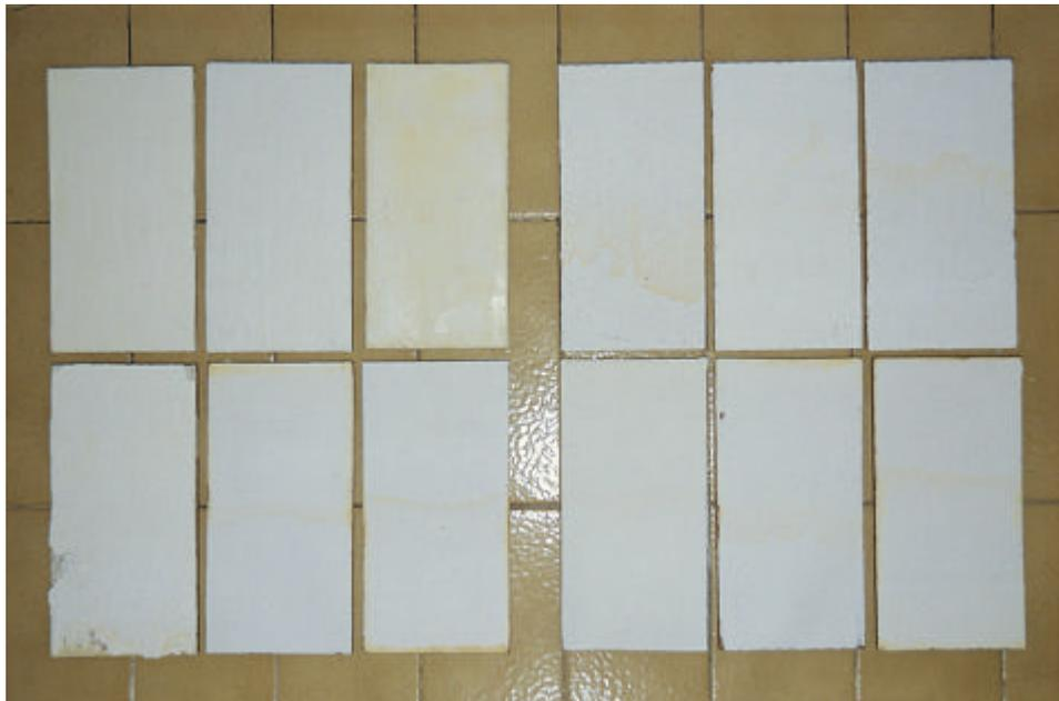
Fig. IV-3. Ensayo de durabilidad de los morteros.
