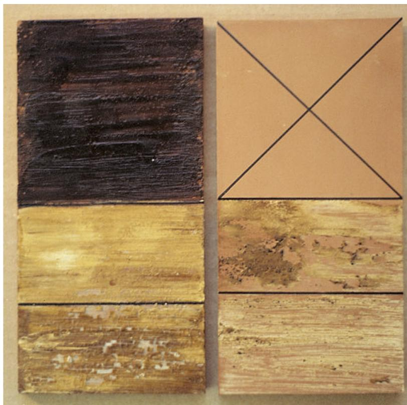
Fig. III-6. Estabilidad y resistencia de la cera montana frente a los disolventes.
