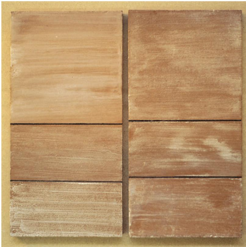
Fig. III- 16. Estabilidad y resistencia de la cera Lanette N frente a los disolventes.
