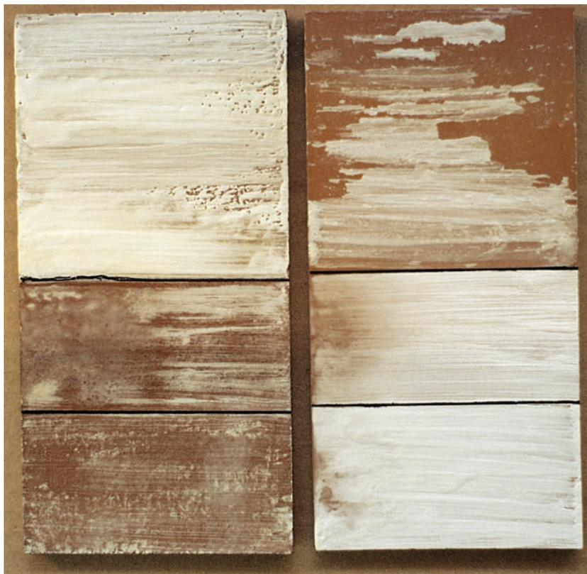
Fig. III-13. Estabilidad y resistencia de la cera de polietileno
