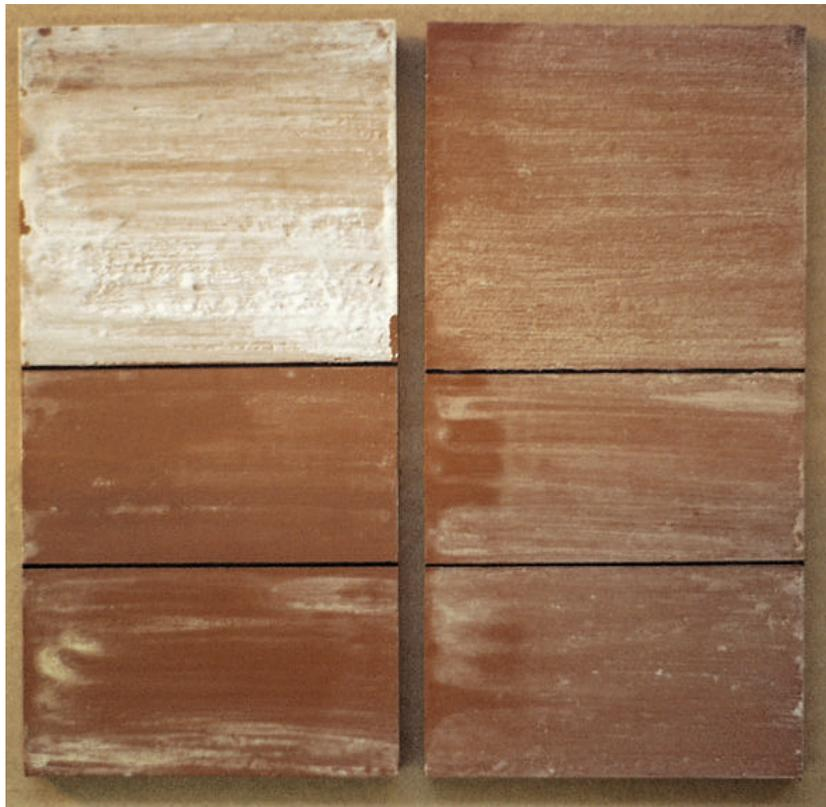
Fig. III-17. Estabilidad y resistencia de la cera Lanette SX frente a los disolventes.
