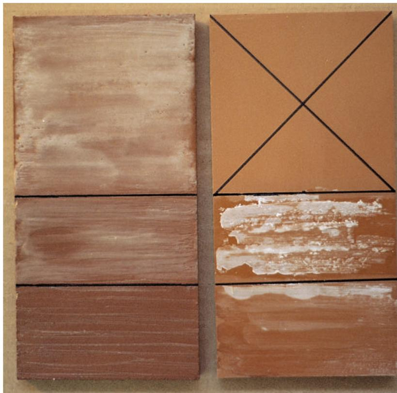
Fig. III-3. Estabilidad y resistencia de la cera esperma de ballena - Spermaceti - frente a los disolventes.
