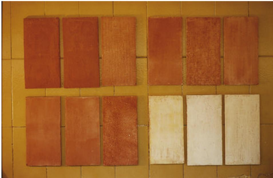
Fig. IV-1. Ensayos de absorción de los morteros.
