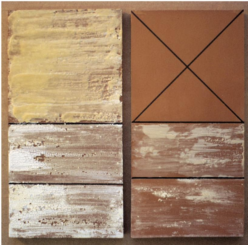
Fig. III-4. Estabilidad y resistencia de la cera carnauba frente a los disolventes.
