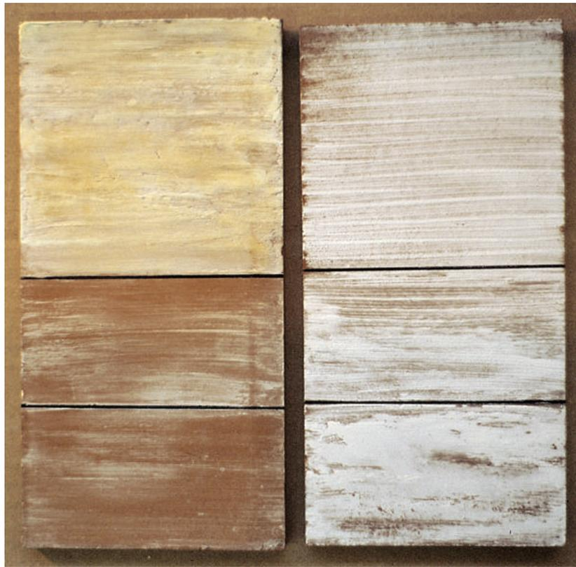
Fig. III-15. Estabilidad y resistencia de la cera Lanette E frente a los disolventes.
