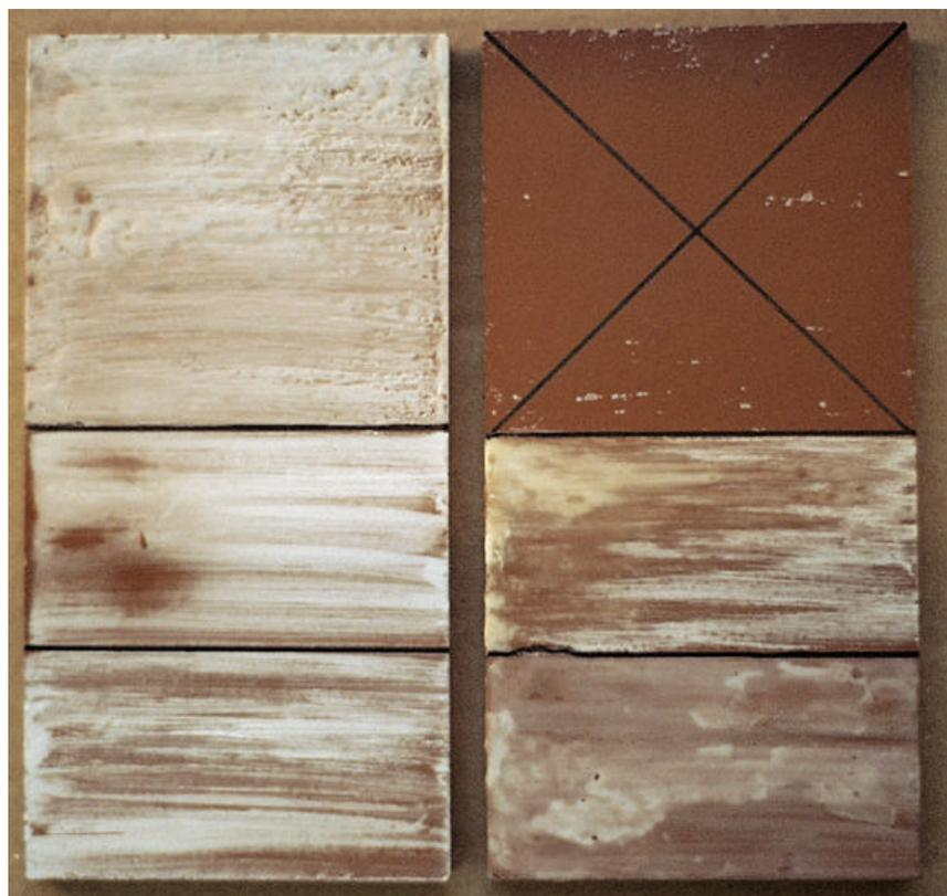
Fig. III- 14. Estabilidad y resistencia de la cera Lanette O frente a los disolventes.
