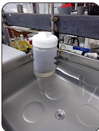
Figura 12. Muestra en el sonicador
