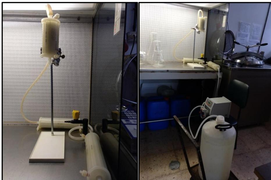
Figura 4. Proceso de filtración del agua marina.
