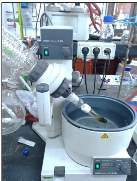
Figura 13. Evaporación del Metanol en el Rotavapor.
