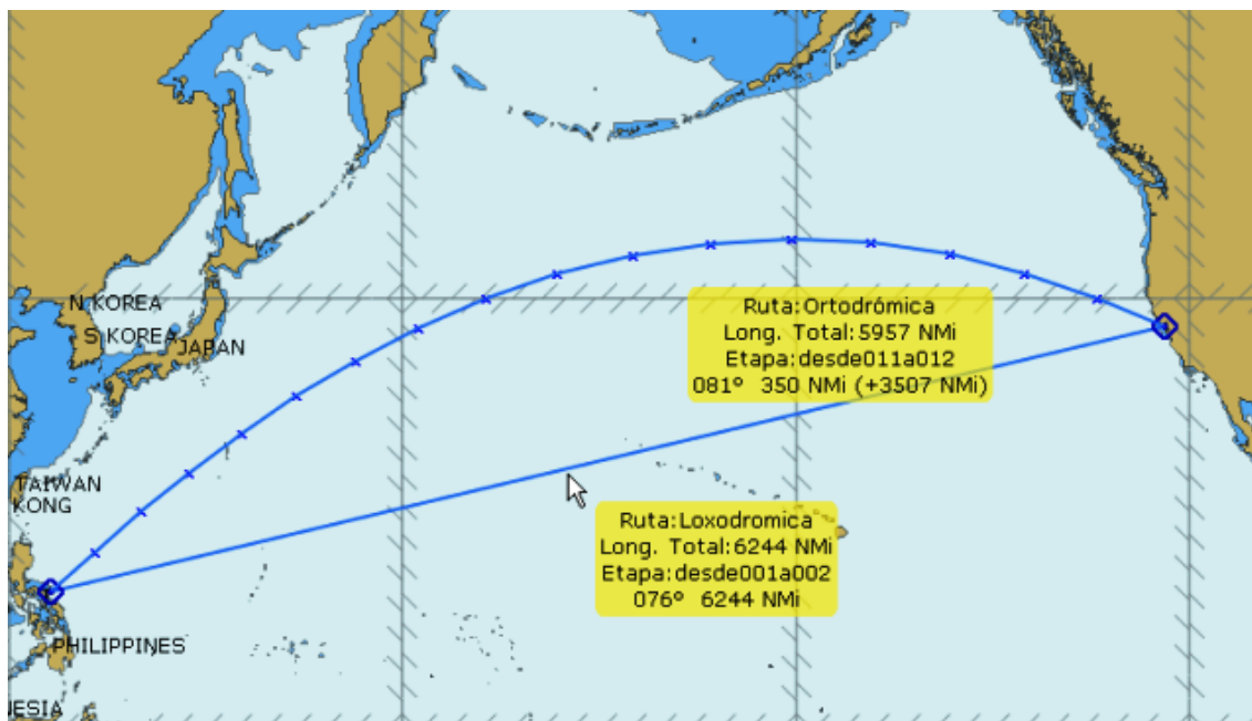
Ilustración 40. Diferencia entre derrota ortodrómica (curva) y loxodrómica (recta). Fuente: https://www.enc.es
