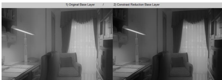
Figura 4.5: Capa base original y capa base aplicada la reducción de contraste ( \gamma = 0.7 )
