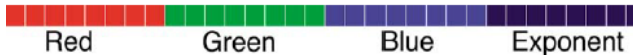
Figura 3.20: Desglose de bits para las codificaciones RGBE (y XYZE) de 32 bits/píxel. Fuente: [1]
