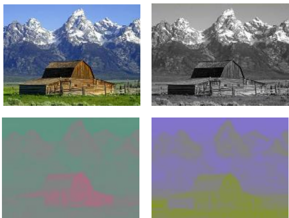
Figura 2.6: Representación de una imagen original y sus componentes Y, Cb y Cr. Fuente:[10]
