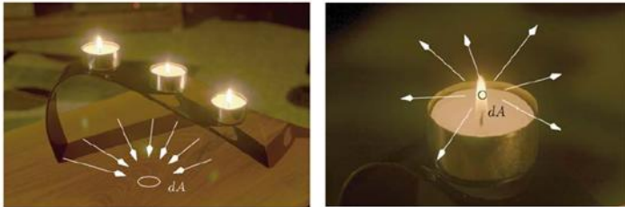
Figura 2.2: A la izquierda, irradiancia: potencia incidente sobre la unidad de área. A la derecha, exitancia radiante: potencia emitida por unidad de área. Fuente: [1]
