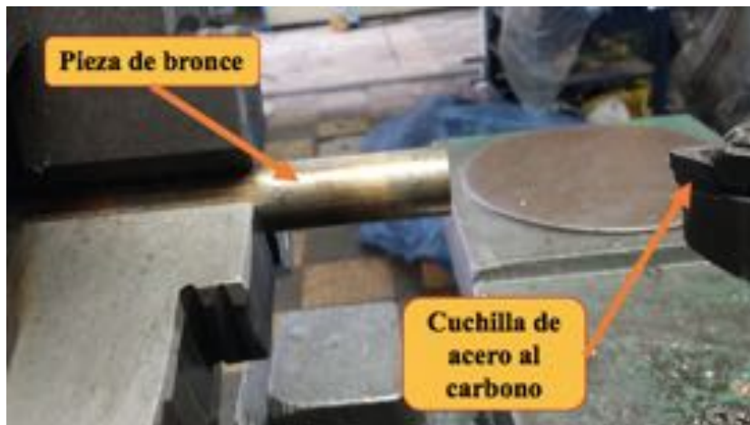
Ilustración n°104: Pieza a punto de ser cilindrada.
