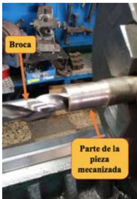
Ilustración n°105: Broca penetrando en la pieza.
