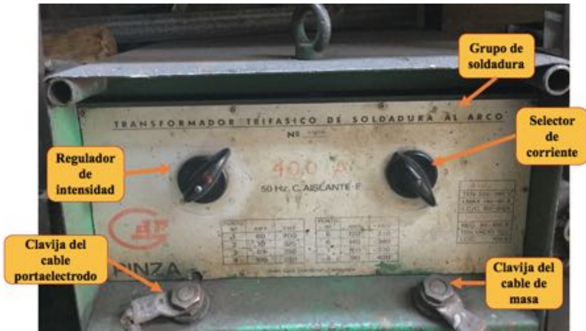
Ilustración n°28: Generador de corriente
