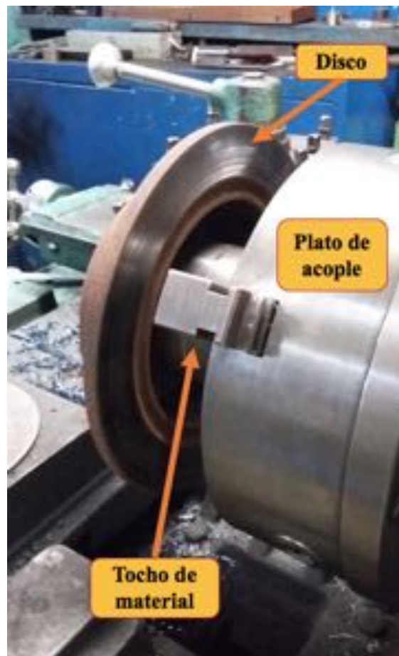
Ilustración n°44: Sujeción del disco (parte interior).
