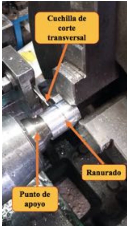
Ilustración n°69: Ejemplo de pieza que se le efectúa un ranurado
