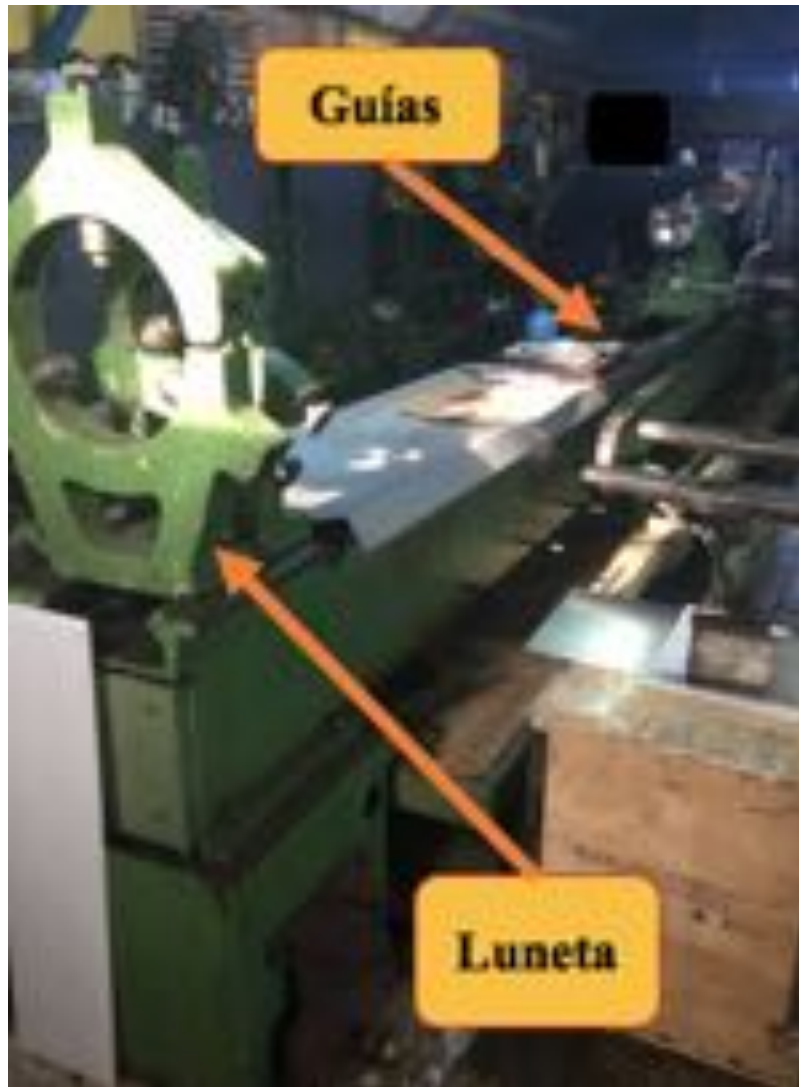
Ilustración n°26: Torno tipo “C10TM”
