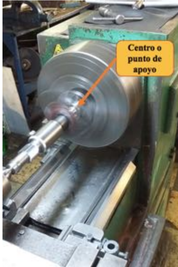
Ilustración n°88: Torno en funcionamiento con el perrillo.
