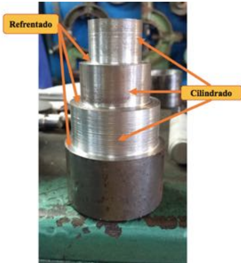
Ilustración n°47: Pieza tanto cilindrada como refrentada
