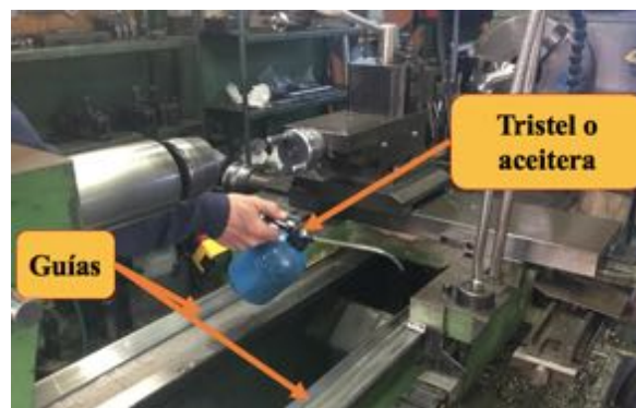
Ilustración n°116: Ejemplo de lubricación de las guías.
