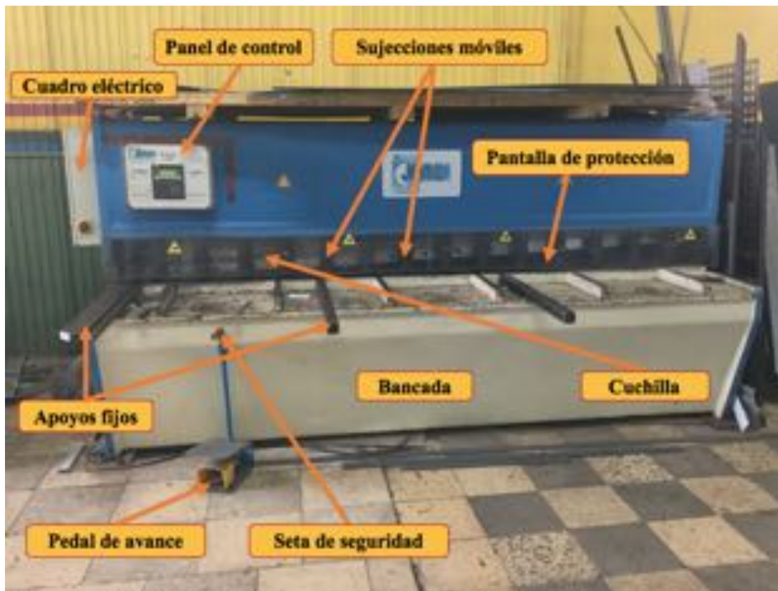
Ilustración n°11: Cizalladora a punto de ser utilizada
