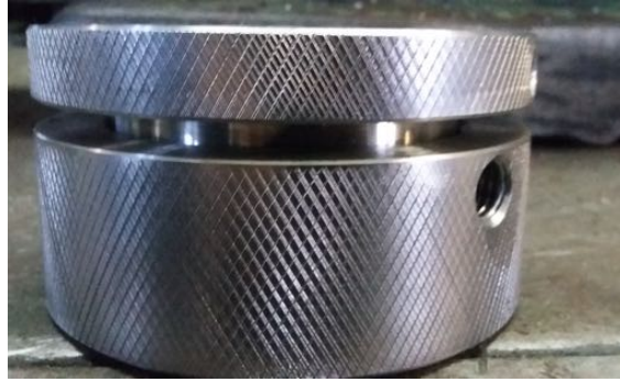
Ilustración n°90: Pieza ya moleteada
