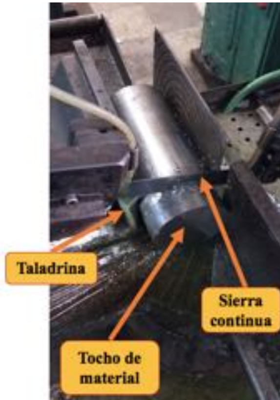
Ilustración n°18: Corte de un tocho de material
