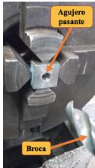
Ilustración n°84: Pieza con un agujero pasante.
