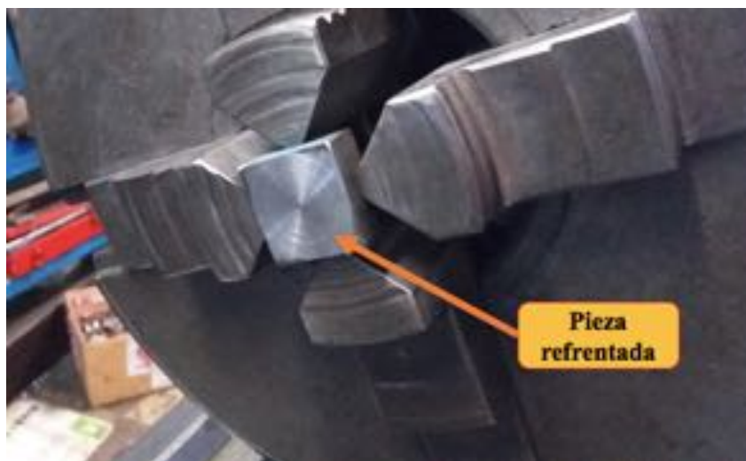
Ilustración n°83: Pieza correctamente refrentada.
