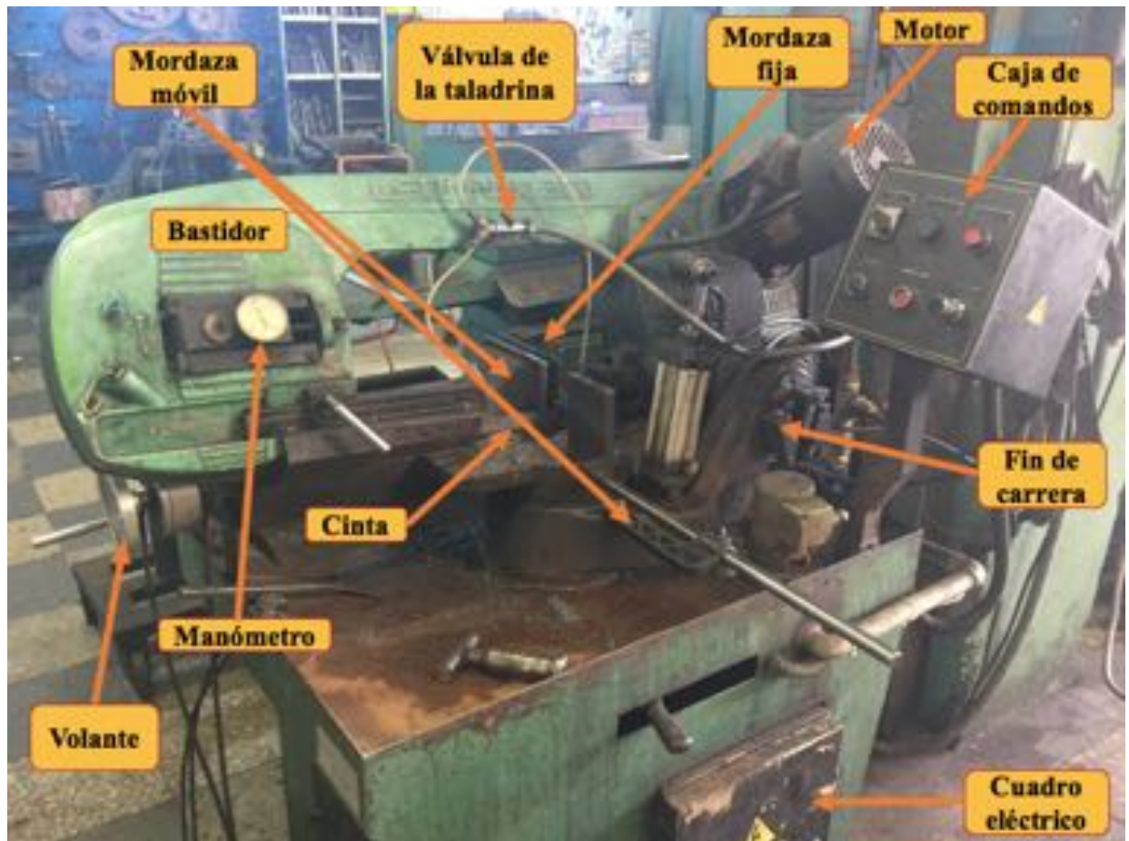
Ilustración n°16: Tronzadora y sus partes.
