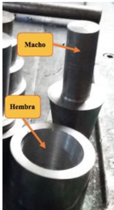
Ilustración n°51: Macho y hembra por separados. Se puede ver que el diámetro exterior del macho coincide con el interior de la hembra.
