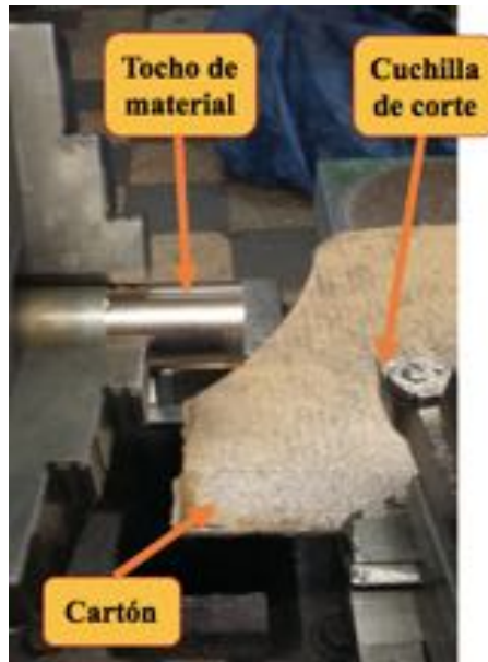
Ilustración n°112: Cilindrado del tocho
