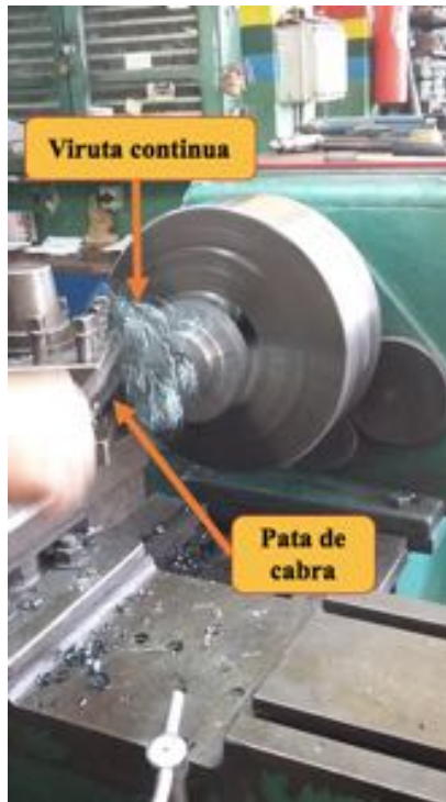
Ilustración n°62: Viruta continua y pata de cabra
