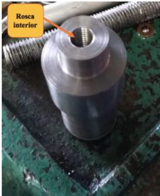
Ilustración n°68: Roscado interior de la pieza
