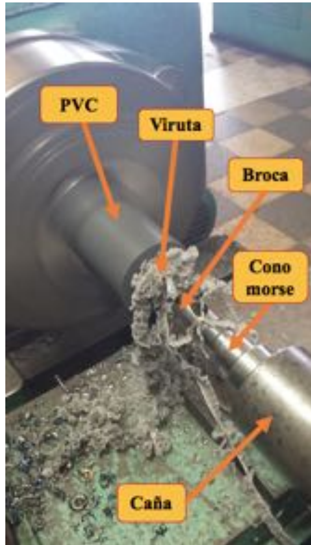
Ilustración nº94: Viruta del PVC
