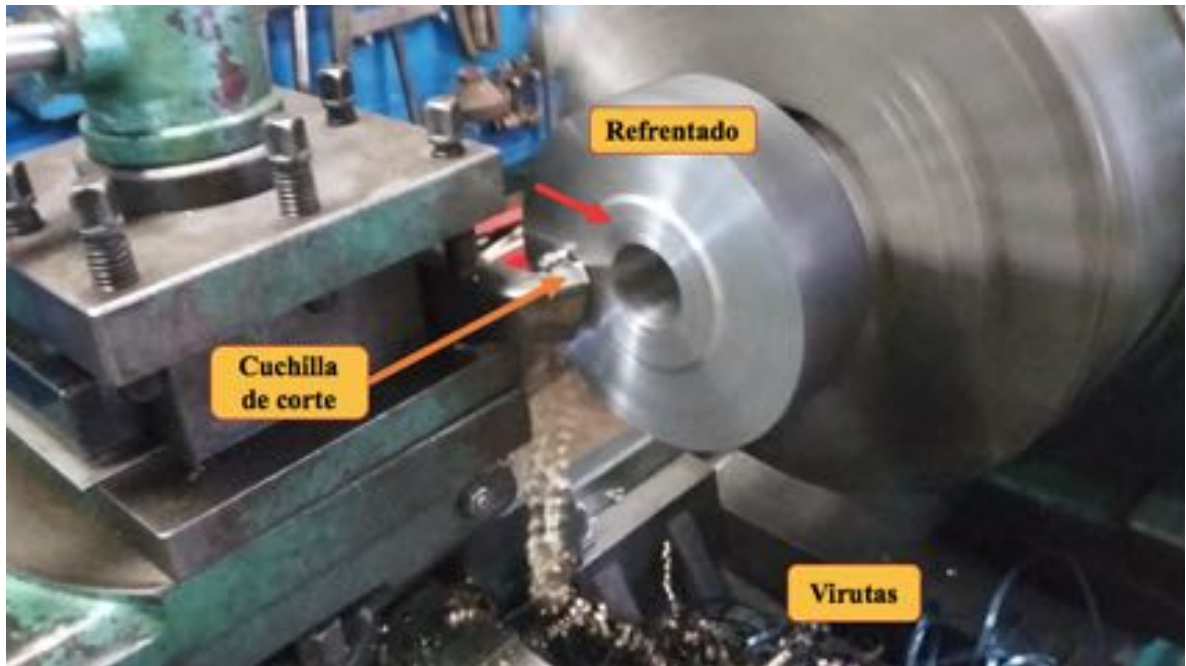
Ilustración n°61: Pieza siendo refrentada en el torno
