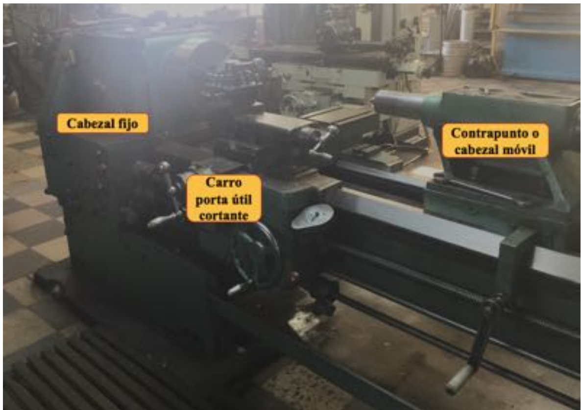
Ilustración n°35: Partes generales del torno
