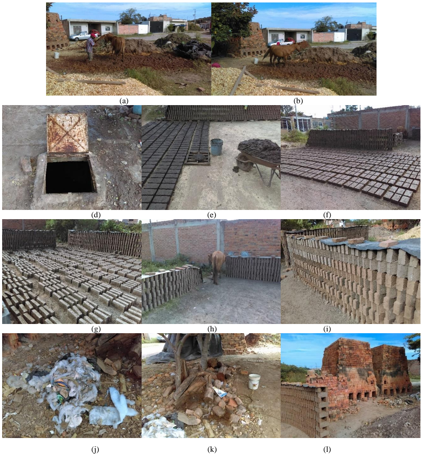
Fig. 012 – Proceso de fabricación de ladrillo tradicional en Tonalá (a)(b) Mezcla de material con caballo (c) Aljibe en sitio. (d) Extrusión de material. (e) Extrusión de ladrillo. (f) Secado de material. (g) Canteado de ladrillo. (h) (i) Secado de ladrillo aparejo traslapado. (j) (k) Basura para quema. (l) Quema y venta de ladrillo
