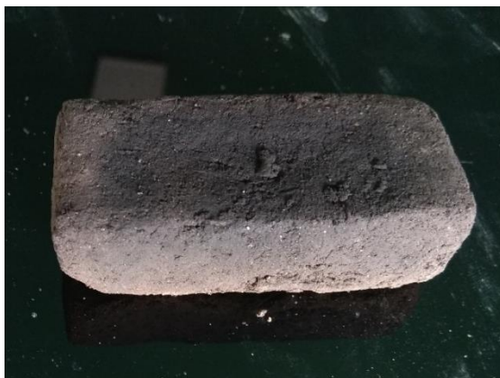
Fig.038 – Prueba ladrillo a escala con cámara de cocción metálica de dos piezas. (a) Pieza resultante del proceso de cocción. Fuente: elaboración propia.
