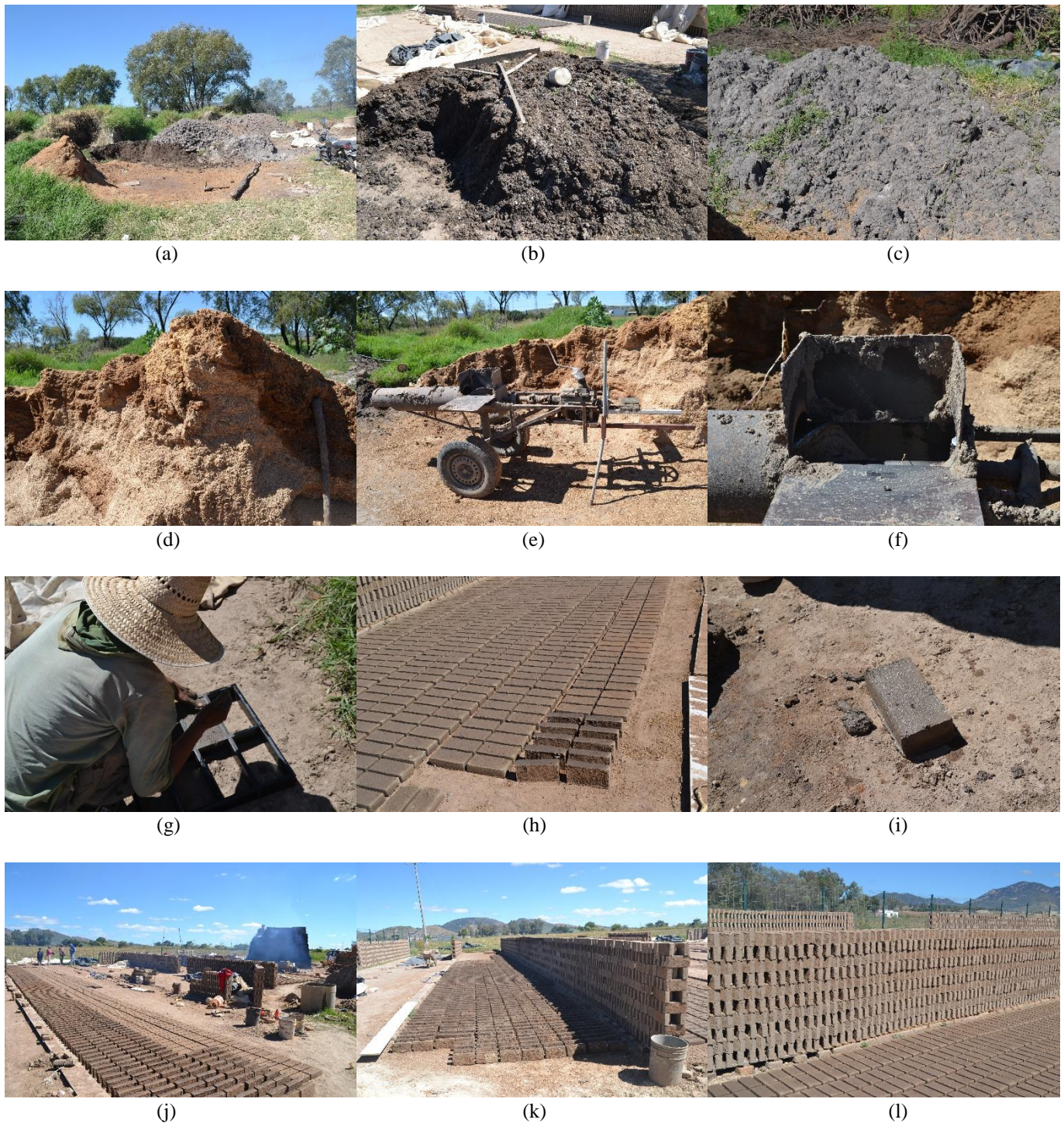
Fig. 013 – Proceso de fabricación de ladrillo tesistán. (a) Recolección de materiales. (b) y (c) Barro. (d) Aserrín. (e) y (f) Máquina de mezclado. (g) Extrusión de material. (h) Desmoldado de material. (i) Secado de material. (j) Secado de material (canteado). (k) y (l) Secado en torres traslapadas.
