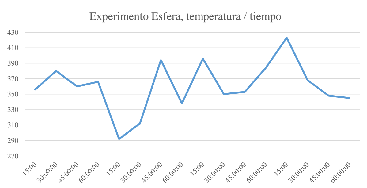
Fig.036 – Gráfica de las temperaturas registradas en las 4 horas de exposición al haz de energía solar. Fuente: elaboración propia.
