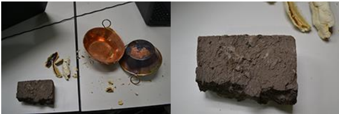
Fig. 023 – Final de la prueba (a) Apertura de la cámara de cocción de cobre. (b) Porción de ladrillo, su estado es muy parecido al anterior a la prueba. Fuente: elaboración propia.
