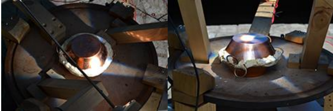
Fig. 022 – Prueba con cámara de cocción de cobre. (a) Haz de energía en contacto con la cara lateral. (b) Haz de energía en contacto con la cara superior. Fuente: elaboración propia.
