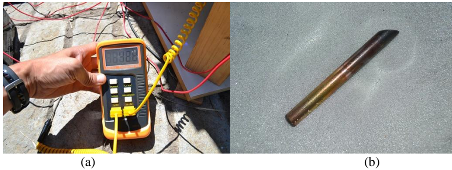
Fig. 017 – Experimento cámara de cocción aluminio. (a) Termómetro digital. (b) Varilla de acero con las marcas del calor aplicado.
