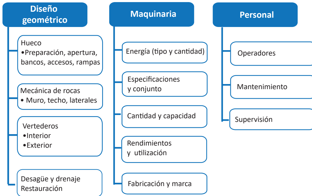
Figura 3. 9. Subprocesos de la etapa de explotación
