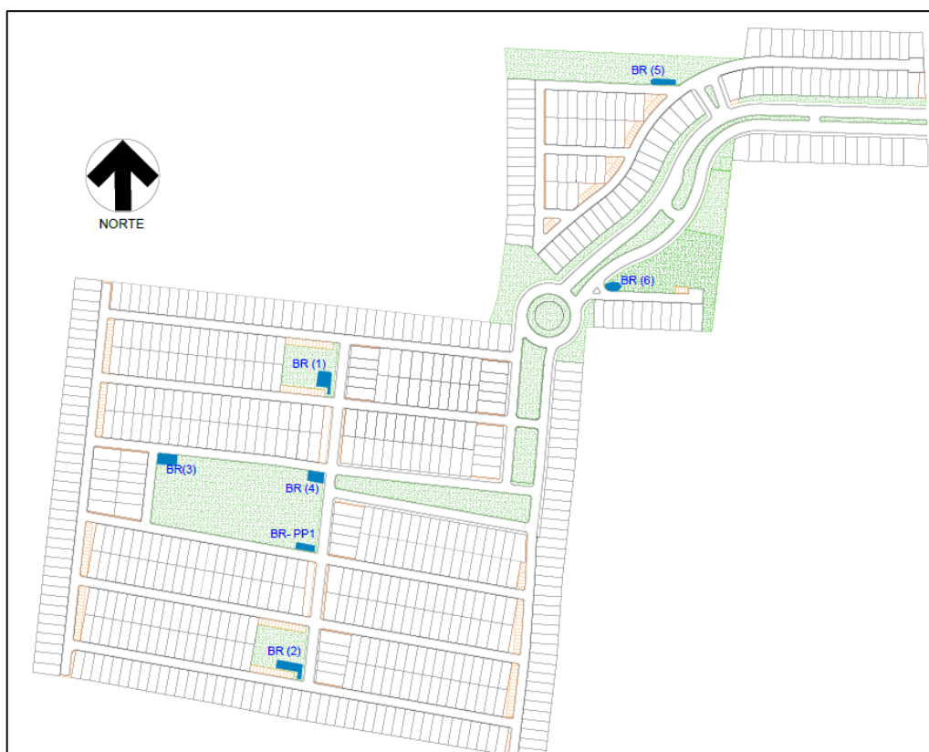
Figura 60. Ubicación de sistemas de biorretención.
