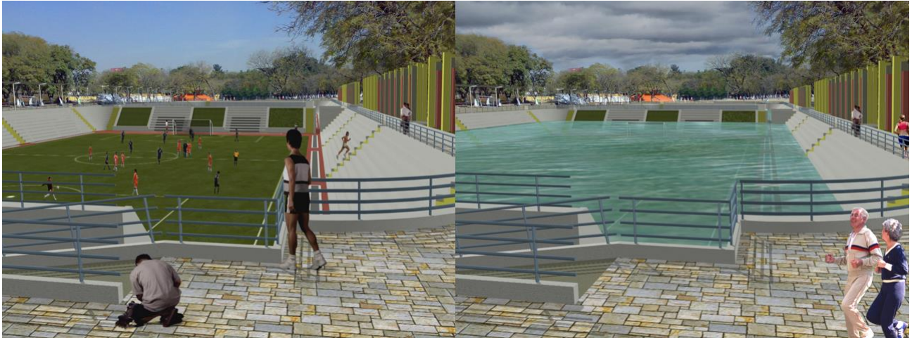
Figura 18. Depósito de regulación López Mateos en canchas de futbol hundidas. Fuente: IHS
