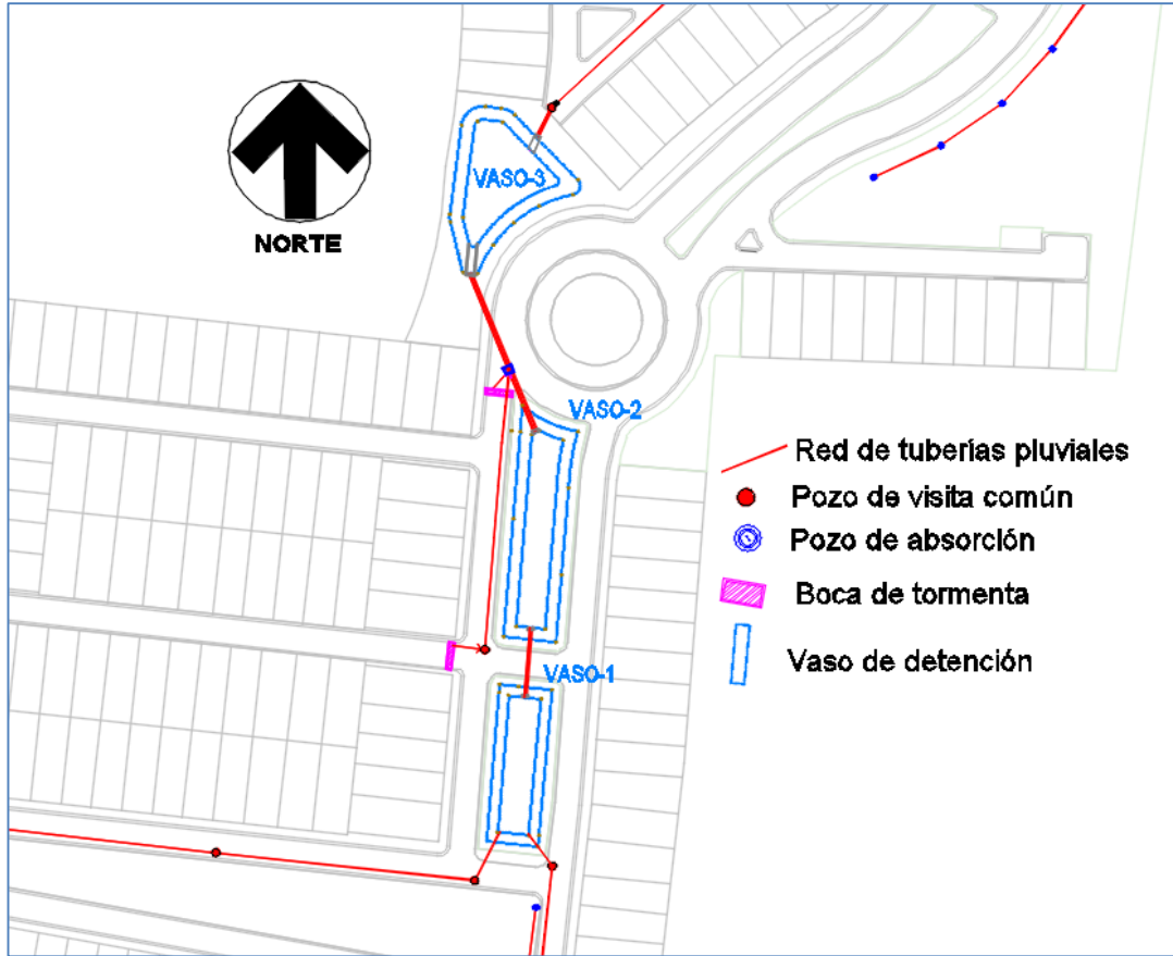
Figura 43. Vista esquemática de la zona central mostrando los componentes del proyecto pluvial convencional del fraccionamiento de estudio.
