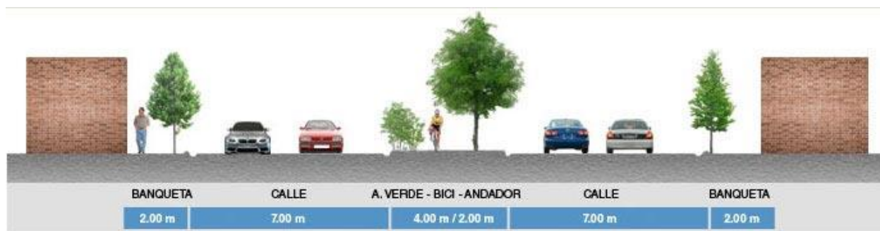
Figura 13: Sección de vialidades secundarias; Fuente: www.elrehilete.com
