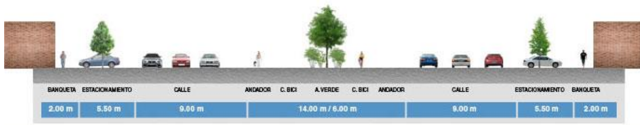
Figura 11 Sección de vialidades principales. Tomado de www.elrehilete.com
