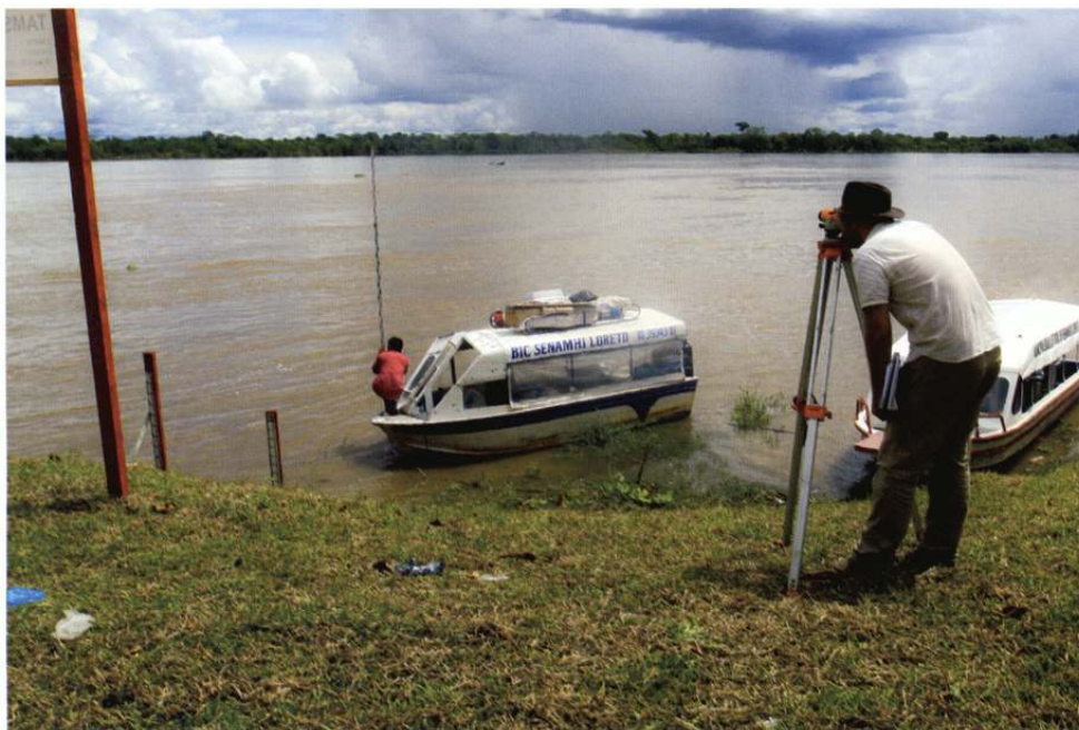
FOTO 3: TRABAJOS DE MANTENIMIENTO EN LA ESTACIÓN HIDROLÓGICA SENAMHI DE TAMSHIYACU (RÍO AMAZONAS, LORETO, PERÚ) ANTES DE REALIZAR UN AFORO. FOTO: © HUANAQUIRI, ROBER.
