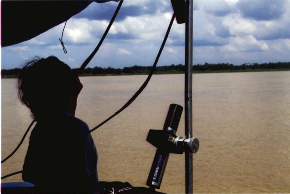
FOTO 4: CALIBRACIÓN DE DATOS SATELITALES DESDE EL RÍO AMAZONAS PARA PROCESAR DATOS DE REFLECTANCIA DE SUPERFICIE DE RÍO Y VOLVER A LA CONCENTRACIÓN EN SEDIMENTOS (BRASIL). EL USO DE LA TELEDETECCIÓN PERMITE COMPLETAR LAS REDES HIDROLÓGICAS CONVENCIONALES. FOTO: © IRD/SANTINI, WILLIAM.
