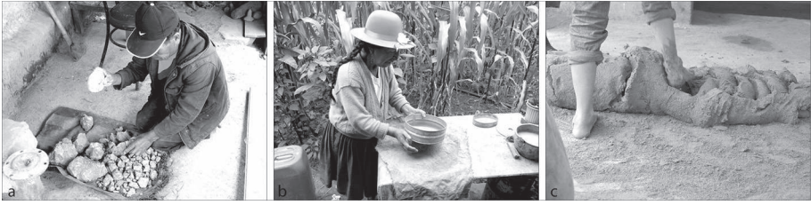
Fig. 8 – Transformation des matières premières : a. concassage ; b. tamisage ; c. pétrissage (photographies C. Lara).
