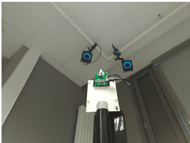
Figure 4.10 Une station de base (ancree) UWB et deux caméras du système Optitrack.
