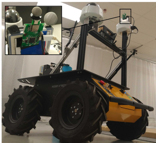
Figure C.1 Robot Husky© et carte UWB utilisée.
