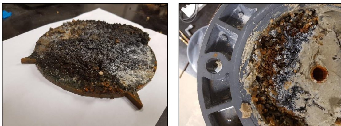
Figure 6.5 : Indications de précipitation préférentielle dans le filtre centripète sur la plaque soutenant le réactif et en surface
