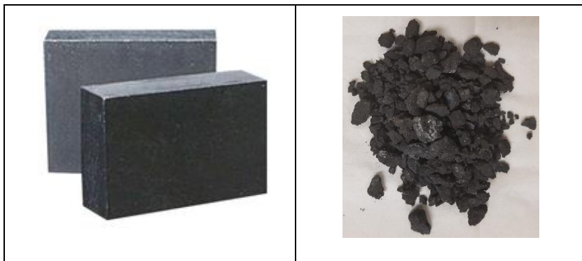
Figure 1.2 : Briques réfractaires de MgO-C avant (à gauche) et après (à droite) avoir été converties en réactif de BPR
