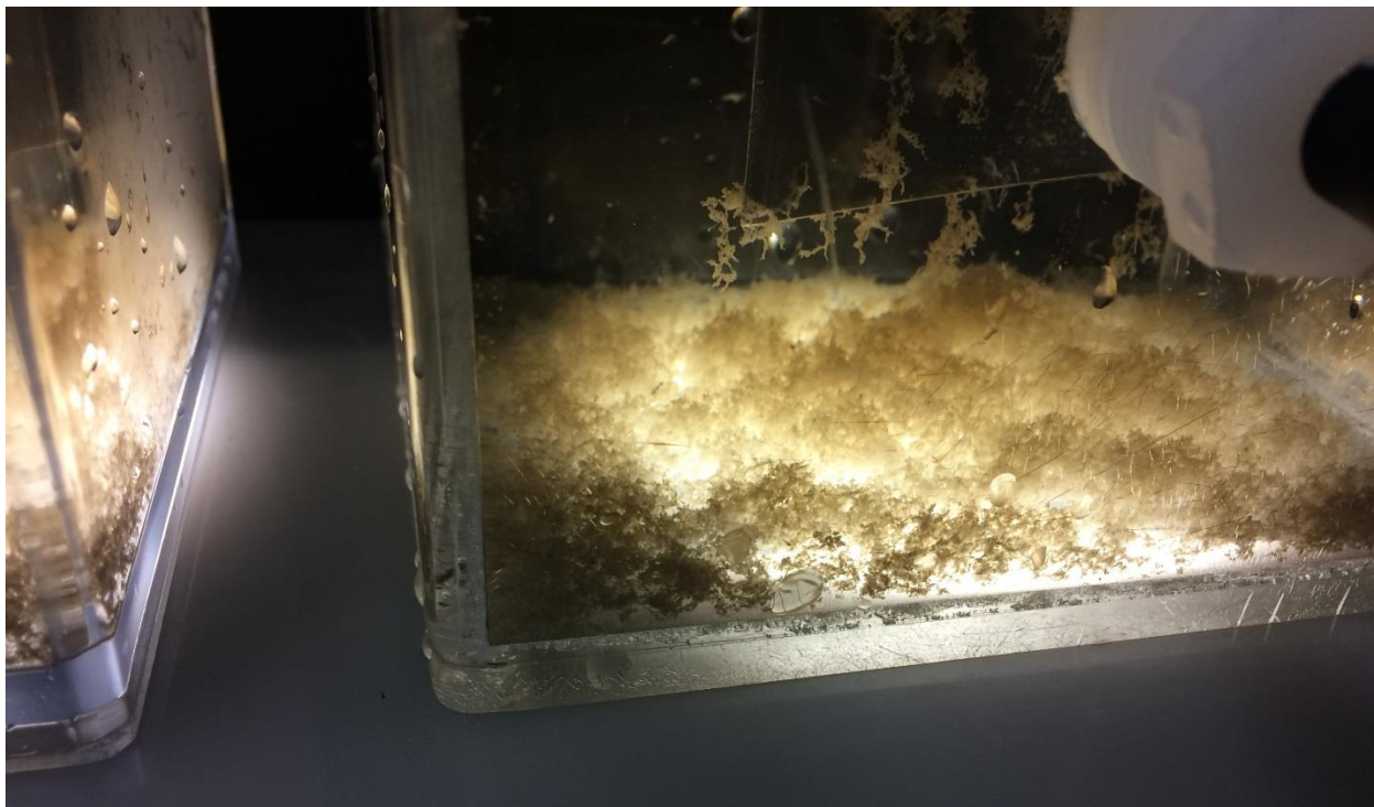
Figure 5-19: Boues restantes après coagulation puis décantation
