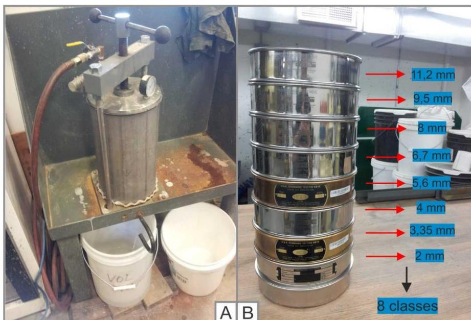
Figure 3.5 : Filtration des fines (A) et classification des granulats (B)
