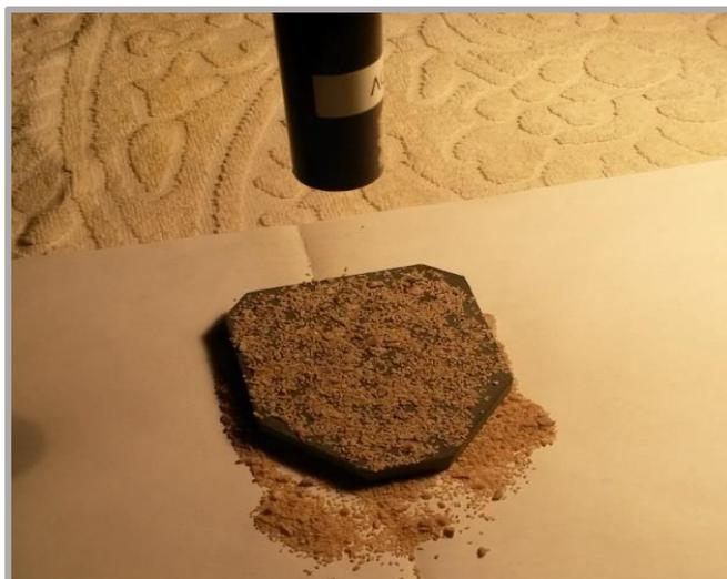
Figure 3.18 : Acquisition des poudres avec le bloc référence (plaquette) sous-jacent
