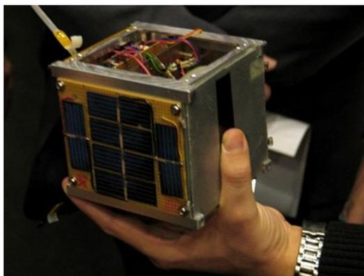
Figure 2-4 Modèle de CubeSat 1U (Figure tirée de [9])
