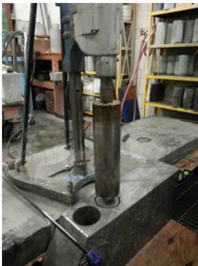
Figure 3-7: Carottage d'un spécimen soumis à un essai de traction directe
