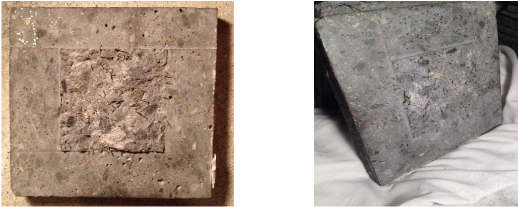
Figure 5-7: Surface de rupture de spécimens soumis à l'essai de cisaillement
