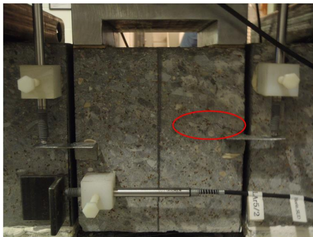
Figure 5-3 : Essai de cisaillement avec fissuration du bloc central
