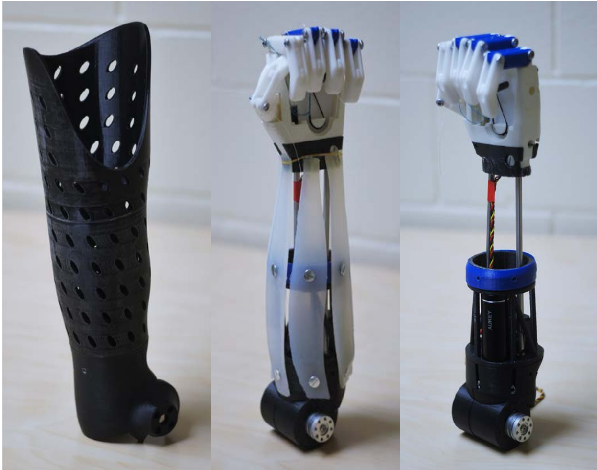
Figure A1-2 : Emboîture (à gauche) ; avant-bras et main avec et sans enveloppe (respectivement au centre et à droite)
