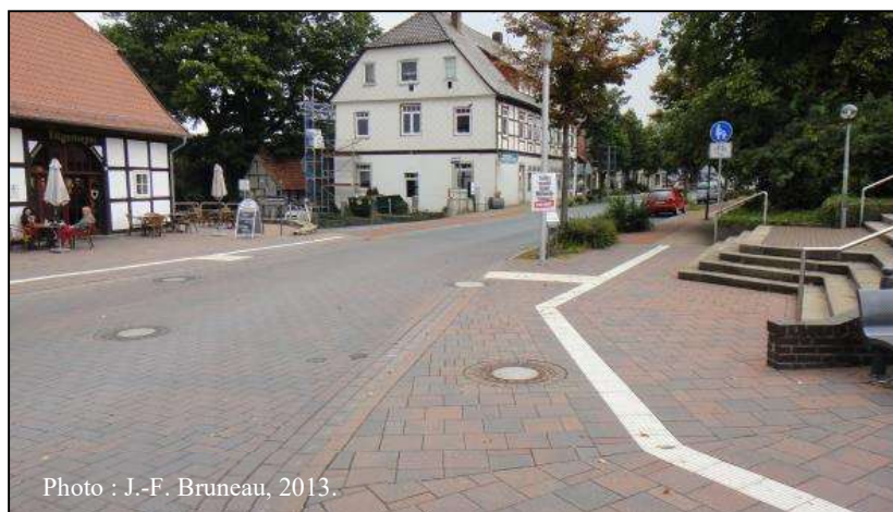
Figure 2.17 : Repères tactiles et passage piéton en shared space (Bohmte, Allemagne)
