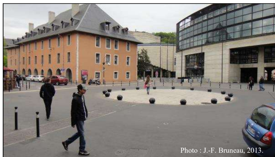
Figure 7.34 : Les piétons peuvent traverser au centre du giratoire (Chambéry, France)
