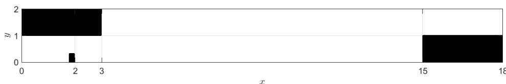
Figure 5.1 Schéma représentatif du domaine de simulation de l'écoulement tourbillonnaire entre deux marches
