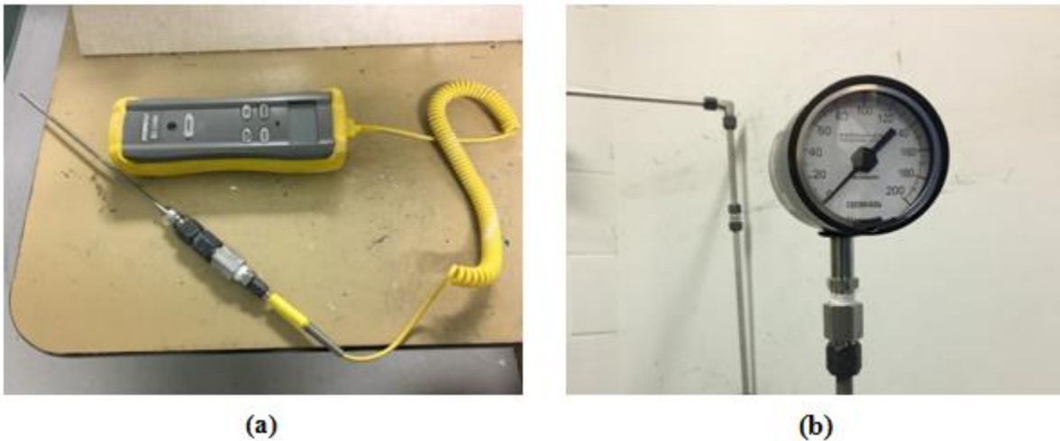
Figure 3.6 : Outils de mesure de la température et de la pression utilisés sur le banc d'essai: (a) Thermocouple et afficheur de température (b) Jauge de pression
