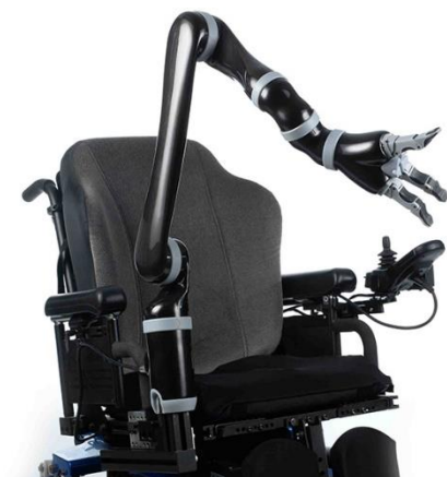
Figure 4-1 Photo du bras robotique d'assistance JACO de Kinova Robotics (Figure tirée de [4])
