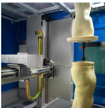
Figure 2-17 Fabrication du négatif du corset par FAO (Tirée de Raux et al. (2014))
