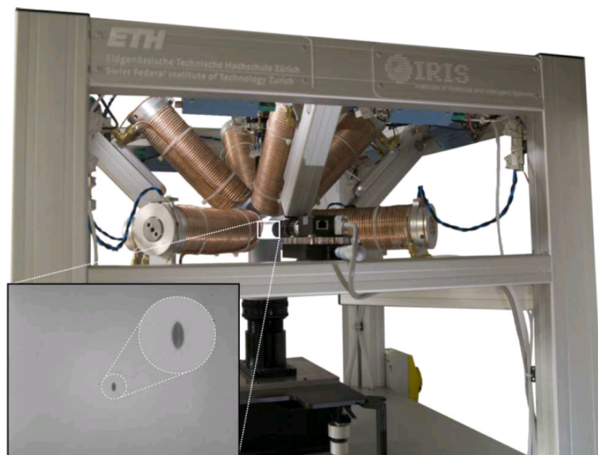
Figure 2.7 Le système Octomag, composé de huit bobines électromagnétiques, permet le contrôle avec cinq degrés de liberté d'un petit dispositif pour accomplir des microchirurgies oculaires. Image tirée de [58].
