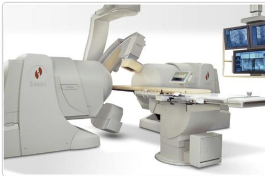
Figure 2.6 Système Niobe de Stereotaxis, composé d'une paire d'aimants permanents dont les rotations sont contrôlées afin d'orienter un dispositif magnétique (cathéter ou capsule endoscopique) dans le corps d'un patient [50].
