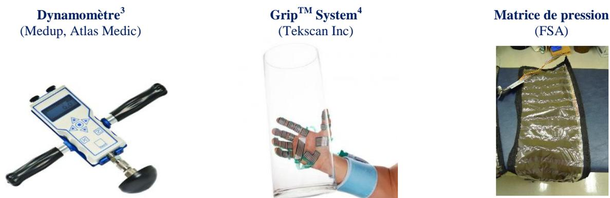
Figure 2.13: Différents outils de mesure de force et pression (© Atlas Medic, © Tekscan, reproduits avec permission. © S.D. Étudiante, 2017)
