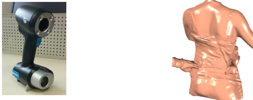
Figure 2.15: Le scanner portable BodyScan et un exemple d'acquisition de la correction manuelle en vue postérieure avec les mains du thérapeute (© S.D. Étudiante, 2017)
